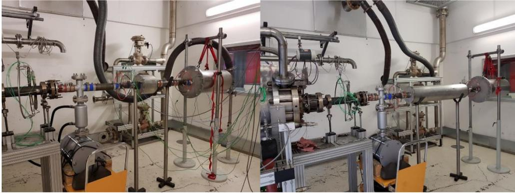
Figure 38: Dispositif expérimental pour les chambres d'expansion
