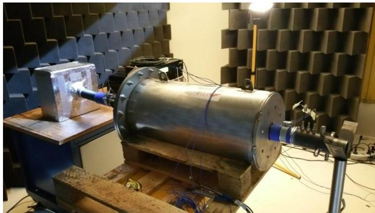
Figure 52 : Dispositif expérimental pour la caractérisation des terminaisons anéchoïques
