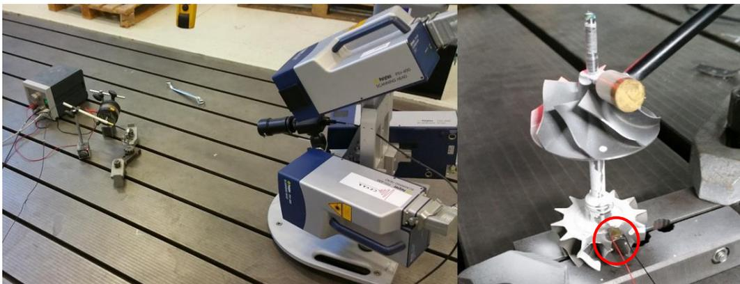
Figure 45 : Dispositif expérimental pour les analyses modales
