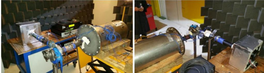
Figure 47: Dispositif expérimental de mesure du TL
