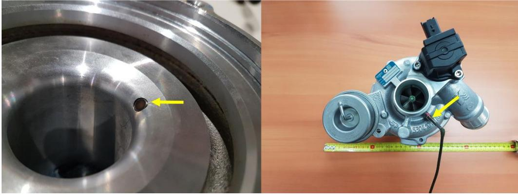
Figure 10: Mesure de la vitesse de rotation du compresseur
