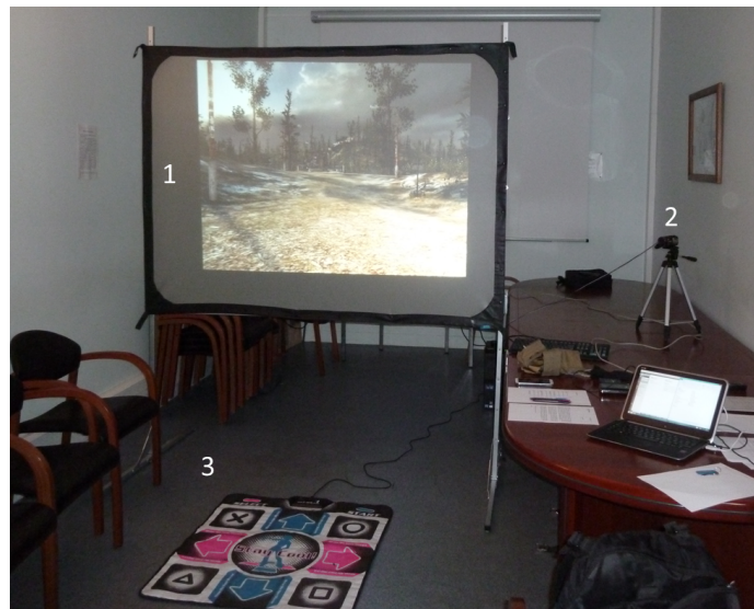
FIGURE 6.4 – Équipement spécifique de d'environnement virtuel : (1) écran vidéo-projeté affichant une scène virtuelle 3D, (2) caméra réalisant un plan en pied du participant et (3) un tapis comportant des zones de pression pour détecter le piétinement du participant.
