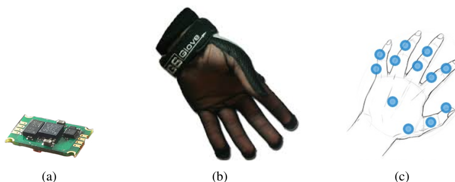
FIGURE 5.7 – Nous avons fait le choix d’un gant IGS-Cobra Glove . Il comporte 12 (a) centrales inertiennes de petite taille, intégrées dans (b) un gant textile double couche et positionnées comme en (c) .
