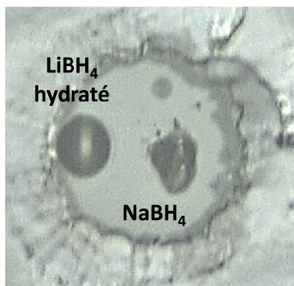
Figure 3 : Photographie d'un échantillon de \text{LiBH}_4 hydraté au côté d'un échantillon de \text{NaBH}_4 après chargement en néon de pureté en eau inférieure à 2 ppm.
