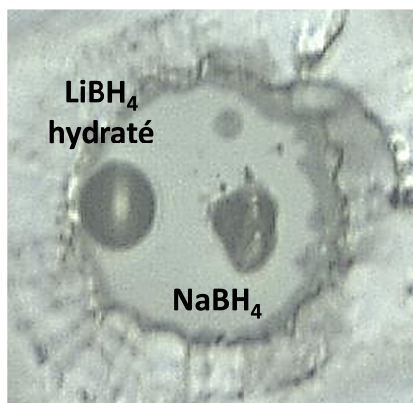
Figure 3 : Photographie d'un échantillon de \text{LiBH}_4 hydraté au côté d'un échantillon de \text{NaBH}_4 après chargement en néon de pureté en eau inférieure à 2 ppm.
