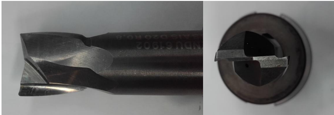
Figure II.25: outil d'usinage par fraisage Ø10 mm à 2 dents utilisé pour obtenir les lots d'états de surface U4.2, U5.5 et U 5.4-TSA.
