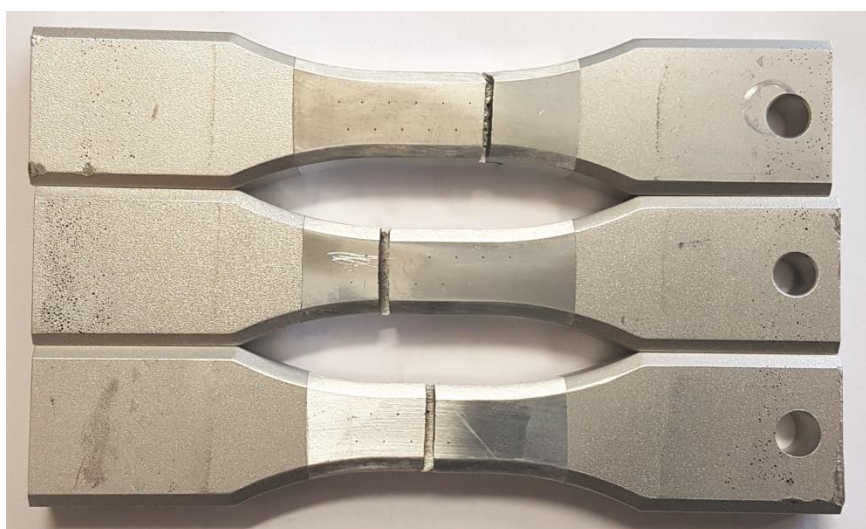
Figure III.9: amorçage de fissure de manière aléatoire sur 3 éprouvettes contenant 22 défauts de \varnothing 200 \mu\text{m} .
