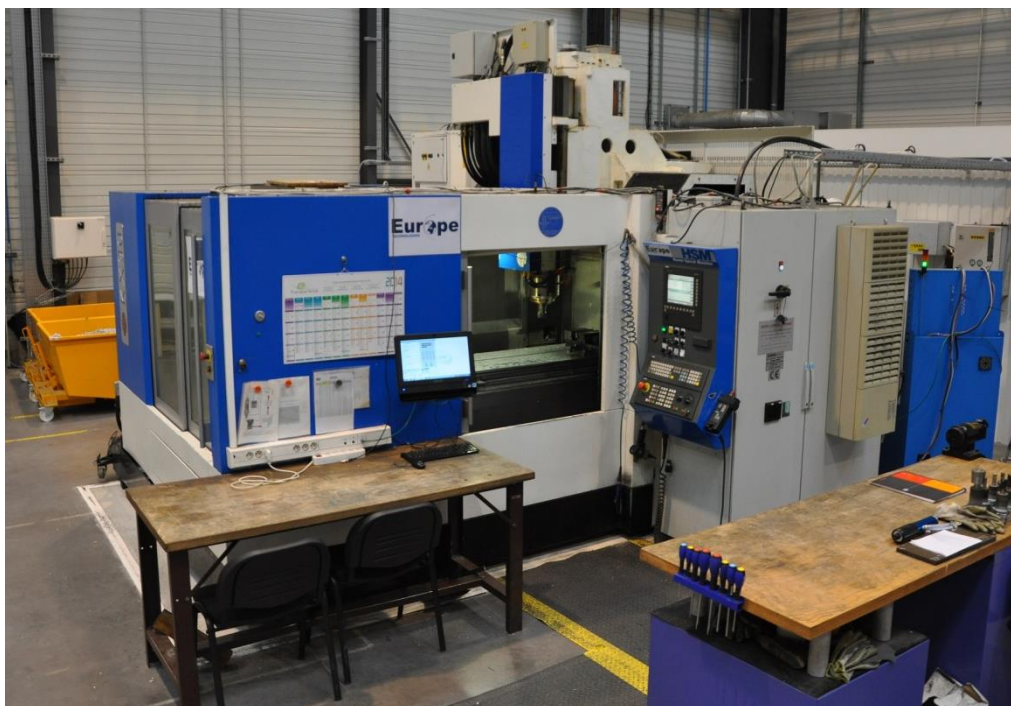
Figure II.24: centre d'usinage de type KX30 permettant d'obtenir des états de surfaces "usinés" par fraisage en bout.
