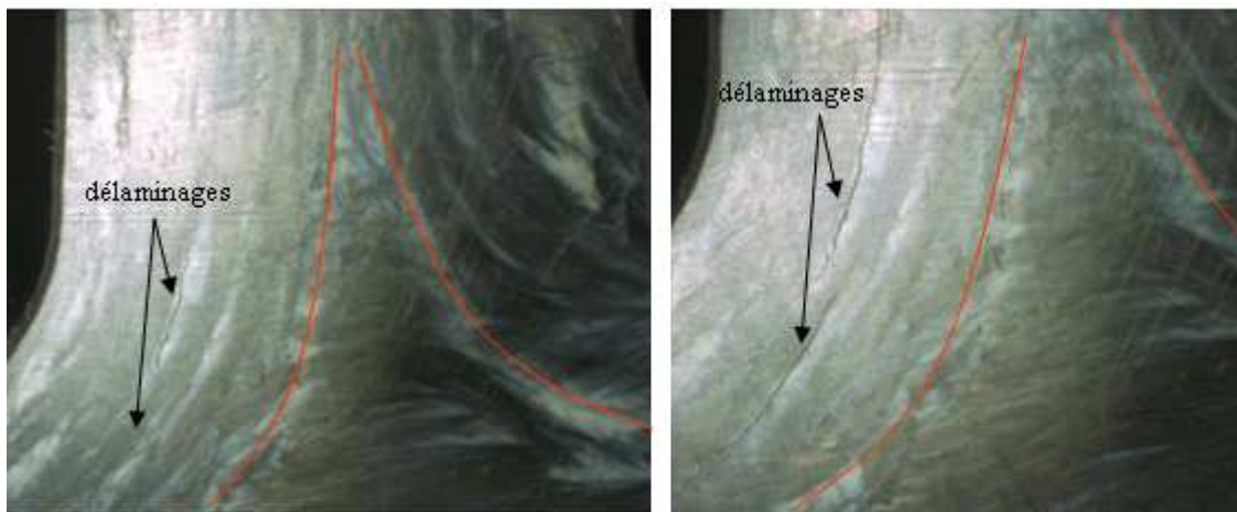
Figure X.30. Etat de la microstructure à 17,5 tonnes de chargement dans le rayon de la chape situé au niveau du point repère A ; les lignes en rouge indiquent les limites de la tête de clou.
