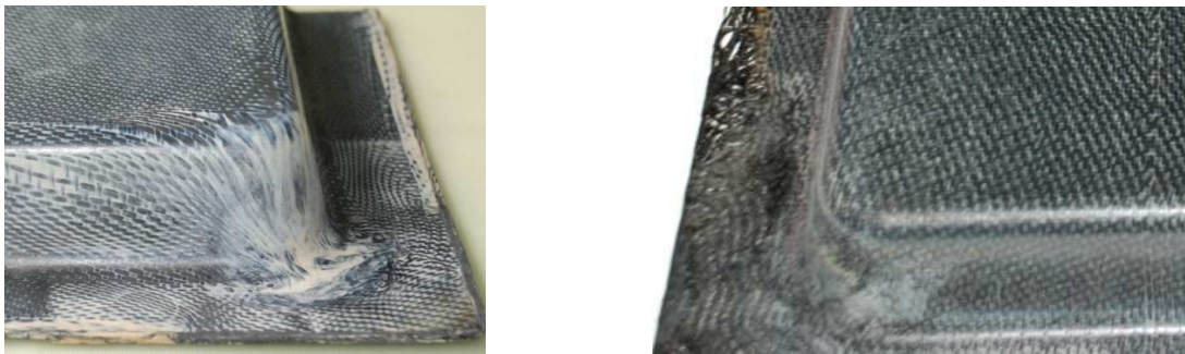
Figure IV. 5. Coins des cuvettes peek_P_satin N° 1 à fibres classiques (à gauche) et peek_S_satin N° 1 à fibres craquées. On peut remarquer la difficulté à épouser le coin qu'ont les fibres classiques par rapport aux craquées.
