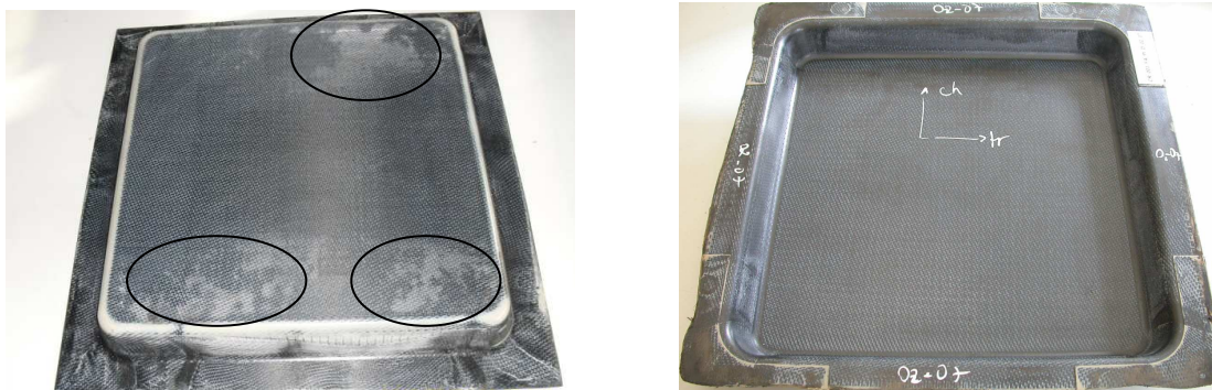
Figure IV. 6. A droite, zones de carence (entourées) et d'amas (contours très blancs du fond plat) de résine sur la cuvette peek_P_satin N°1 ; à gauche, aspect final après rallonge de 5minutes du palier de pression intermédiaire.
