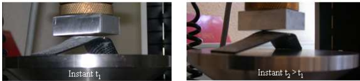
Figure X. 17. Photographies de l'essai prises à deux instants t_1 et t_2 ( t_1 < t_2 ) ; mise en évidence du changement du mode de sollicitation au cours de l'essai qui est source de non linéarités sur les courbes expérimentales.
