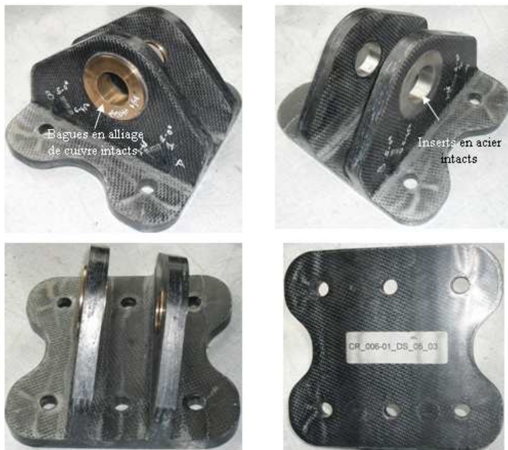
Figure X. 32. Aspect extérieur sous différentes vues de la chape après une sollicitation de 19 tonnes à 0,5mm/min suivant l'axe Z du repère lié à l'avion.
