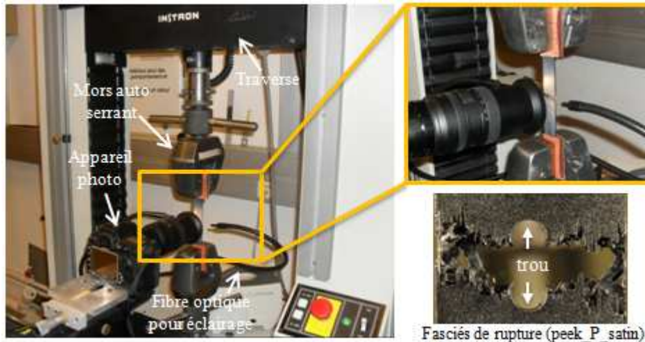
Figure III. 45. Dispositif expérimentale de traction sur éprouvette trouée et exemple de faciès de rupture.
