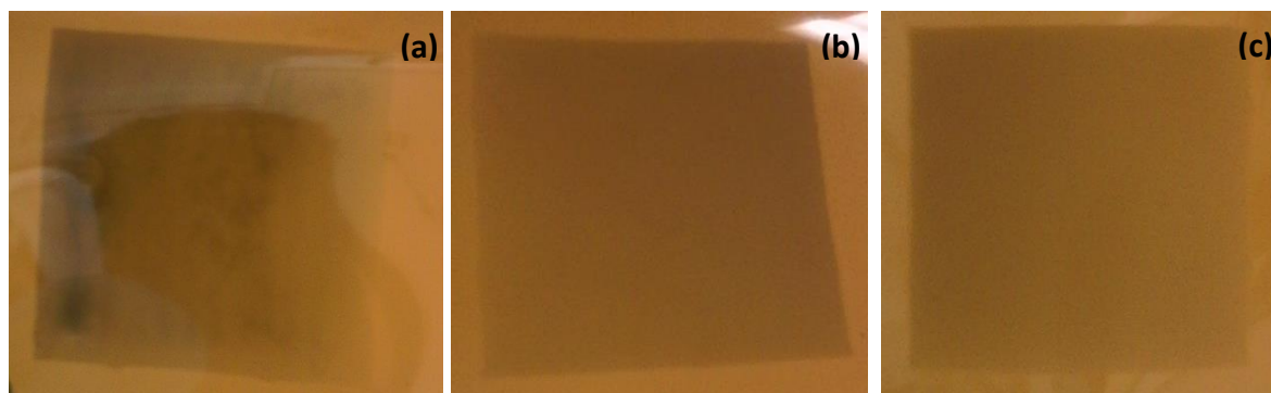
Figure 88: Dépôt par le robot spray de A6SS100 + Nafion (a) vitesse de la buse = 5 mm/s, (b) vitesse de la buse = 20 mm/s, (c) vitesse de la buse = 50 mm/s
