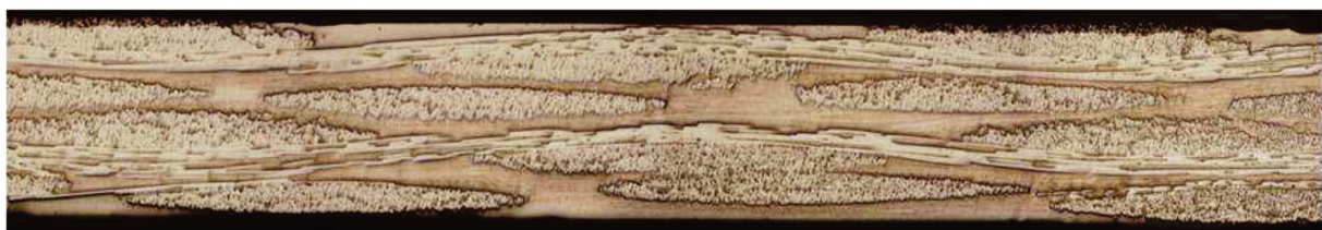
FIGURE 1.7 – Observation de l'arrangement microstructural dans un composite tissé à matrice organique ([Couegnat, 2008])
