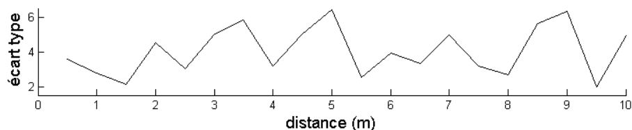
FIGURE 3.6 – Evolution de l'écart type des mesures RSS Bluetooth en fonction de la distance
