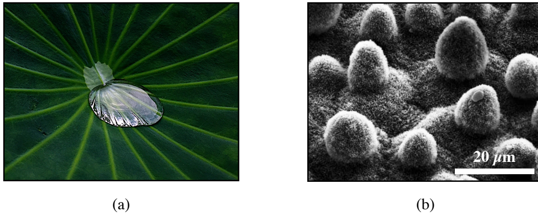
FIGURE 11 – (a) Photographie d'une goutte d'eau sur une feuille de lotus Nelumbo nucifera du parc de Ueno à Tokyo. Le reflet argenté trahit la présence d'air piégée dans les rugosités sous la goutte. (b) Détails vus au MEB des rugosités présentes à la surface de la feuille de lotus. Adapté de Barthlott et al. [2].
