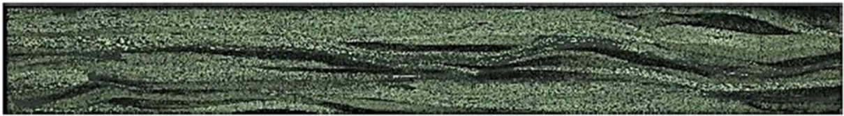
Figure 2-19 : reconstitution de la surface balayée à partir des micrographies acquises d'un échantillon AC-SMC RO.
