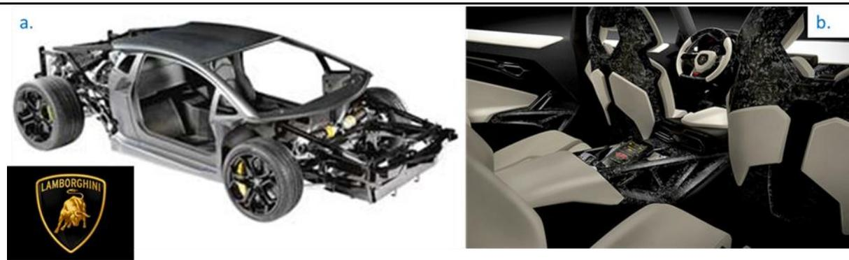
**Figure 1-12:** a. Structure portante de la concept car Aventador "sesto elemento" [37], b. Habitacle de la Venento avec ses sièges en AC-SMC, [38] [39].
