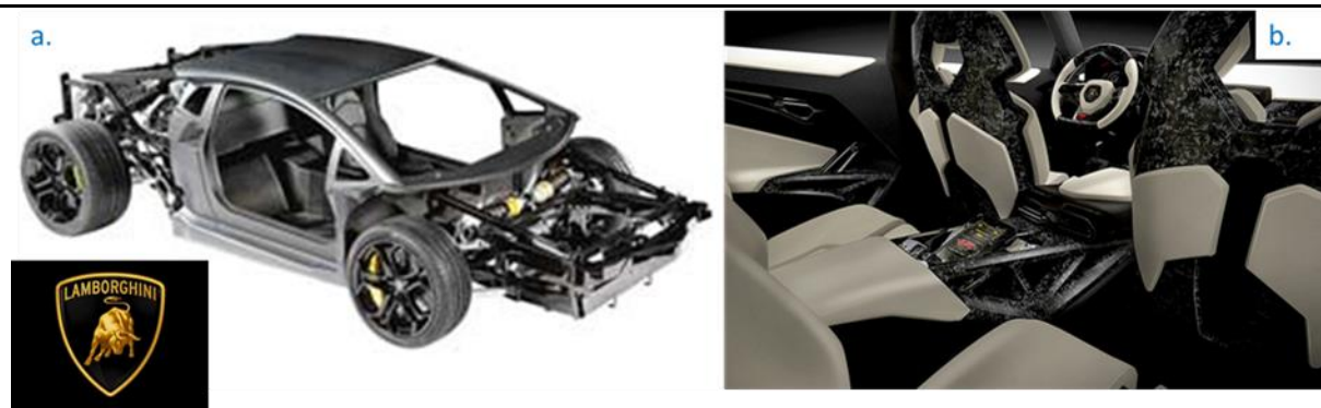
Figure 1-12: a. Structure portante de la concept car Aventador "sesto elemento" [37], b. Habitacle de la Venento avec ses sièges en AC-SMC, [38] [39].
