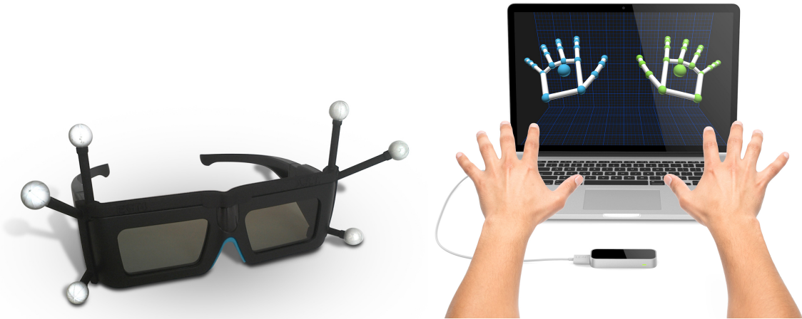
FIGURE 4.14 – Deux dispositifs de tracking optique, avec et sans marqueurs. Du fait des marqueurs, le système de gauche (A.R.T.) est plus fin et précis que celui de droite (Leap Motion), et a un champ de détection plus large.
