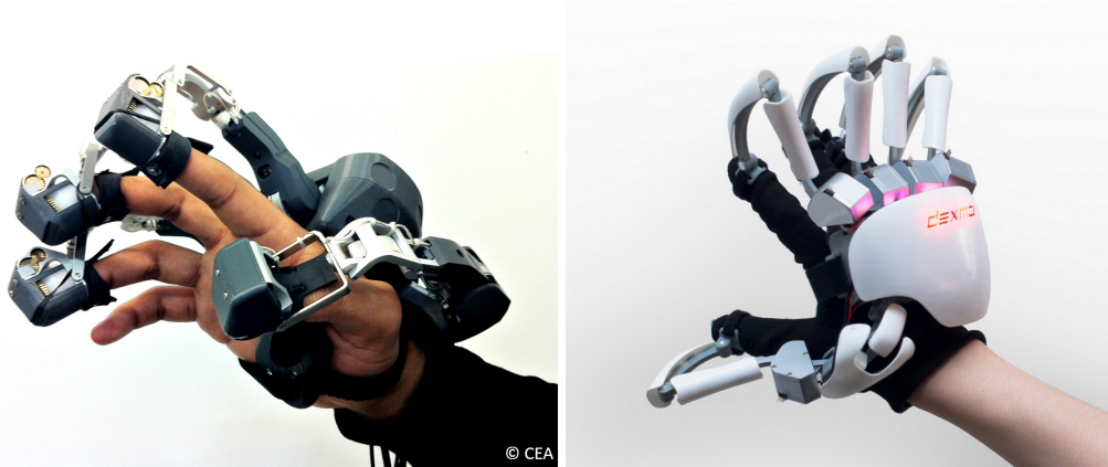
FIGURE 4.7 – À gauche le MANDARIN conçu en collaboration entre le CEA, Haption, INRIA, Renault, et l'ANR. À droite le Dexmo, conçu par Dexta Robotics [Gu et al., 2016]. Ces exosquelettes se fixent sur la main et en contraignent les phalanges grâce à des articulations mécaniques, ajoutant même parfois un retour cutané au bout des doigts.
