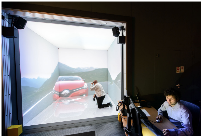
FIGURE 3.2 – Le CAVE IRIS de Renault. IRIS (Immersive Room and Interactive System) est un CAVE de cinq faces de 3m par 3m affichant plus de 80 millions de pixels au total. Il utilise 18 vidéoprojecteurs en projection indirecte sur des matériaux semi-transparentes, le tout piloté par une vingtaine de cartes graphiques de dernière génération. Le tracking des yeux est réalisé par un système de la société A.R.T.
