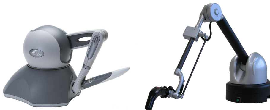
FIGURE 4.6 – Le PHANTOM Omni de SensAble Technology, inc et le Virtuouse 6D de Haption. Ces appareils dotés de 6 degrés liberté sur un outil pointeur ont su démocratiser l'usage des bras haptiques. Le PHANTOM Omni offre une résistance de presque 1N en continu, et un peu plus de 3N ponctuellement selon la position de l'appareil.
