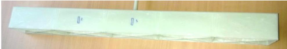
Figure 5-6 : vue de côté de la poutre à croisillons
