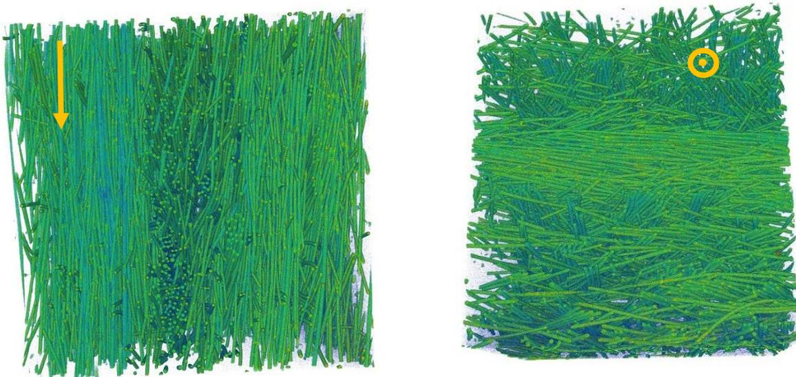
Figure 1-12 : visualisation de la microstructure en cœur peau du PPGF30 avec une orientation des fibres dans le sens de l'écoulement dans les zones de peau et une orientation orthogonale au sens d'injection dans la zone de cœur (le sens de l'écoulement est représenté par les flèches)
