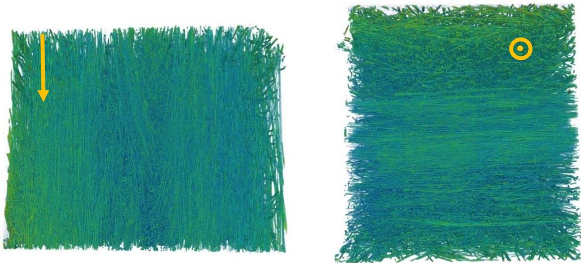
*Figure 1-13 : visualisation de la microstructure en cœur-peau du PPGF40 avec une orientation des fibres dans le sens de l'écoulement dans les zones de peau et une orientation orthogonale au sens d'injection dans la zone de cœur (le sens de l'écoulement est représenté par les flèches)*
