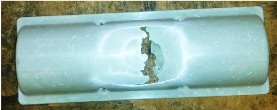
Figure 5-19 : gouttière impactée à une vitesse de sollicitation de 5m/s
