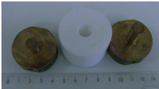
Figure 27 Les électrodes de cuivre et le corps en Téflon utilisés lors des mesures de conductivité électrique
