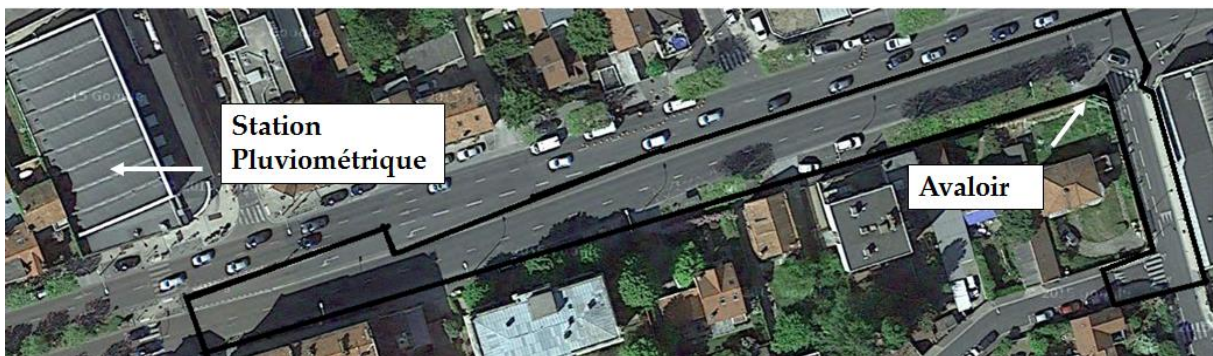
Figure 2-2 Le bassin versant routier délimité en noir et les localisations de la station de pluviométrique et de l'avaloir (Google Map@2016)
