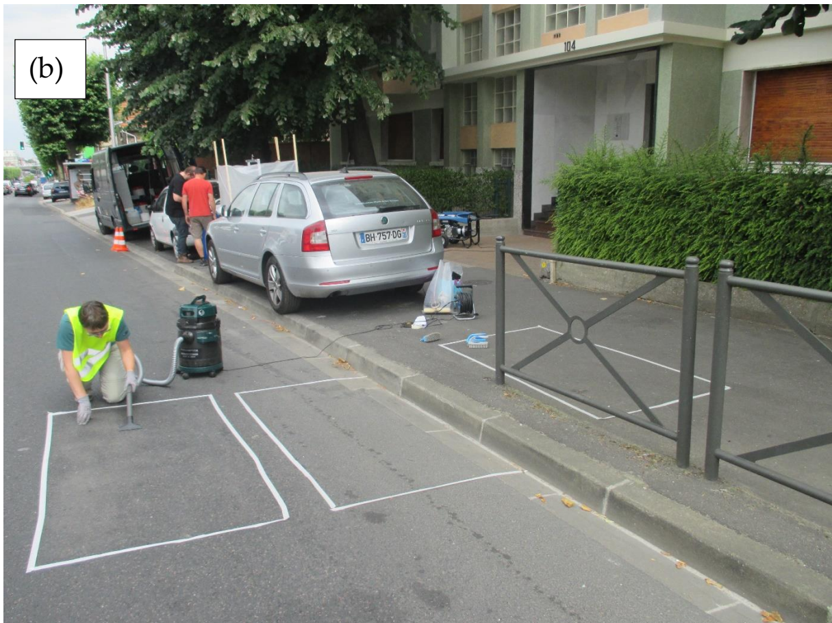
Figure 2-4 (a) Les localisations où les campagnes de dépôts secs sont effectuées ; (b) Les trois positions de collecte des dépôts sur la localisation (1).
