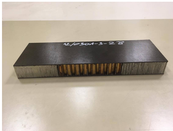
FIGURE A.1 – Échantillon sandwich - Peaux en CFRP, Cœur nida en alliage d'Alu
