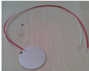
FIGURE 6.2 – PZT NCE51 de Noliac de diamètre 25 mm
