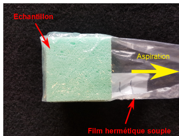
FIGURE 3.12 – Illustration du film hermétique utilisé pour envelopper les échantillons.
