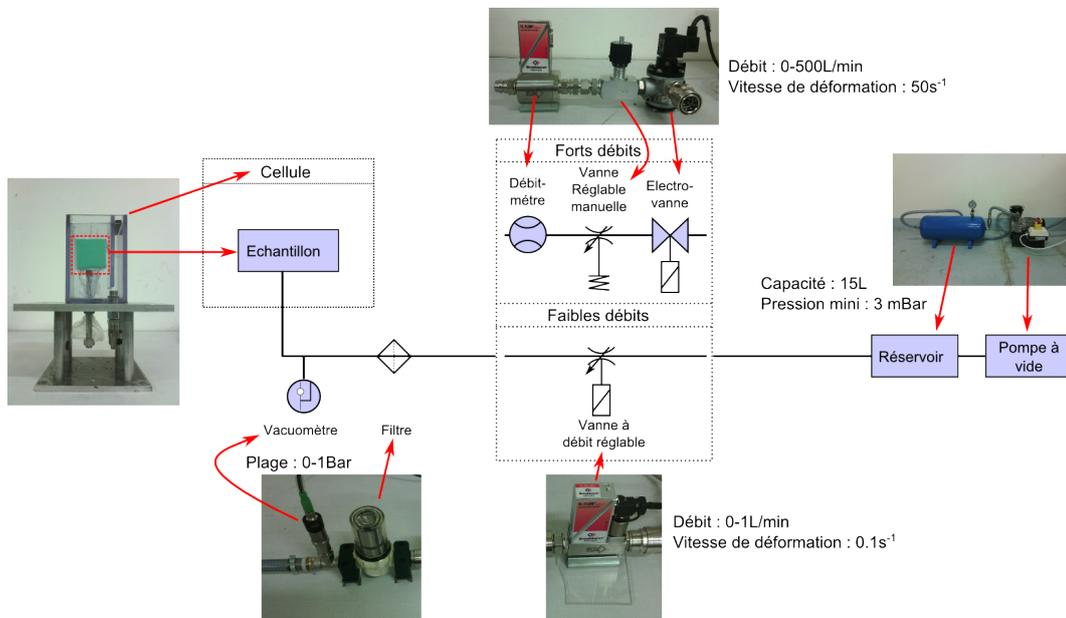
FIGURE 3.13 – Système d'aspiration développé.
