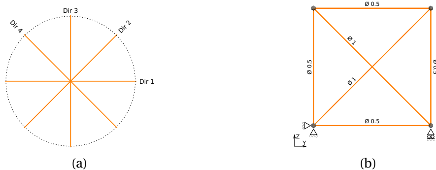
FIGURE 4.43 – Illustration des directions de discrétisation d'un élément 2D, utilisées dans cette étude (a). Maillage éléments finis reprenant les directions de discrétisation (b).
