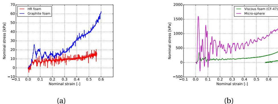
FIGURE 2.21 – Résultats des essais d'impact sur un matériau représentatif pour chaque familles de matériaux
