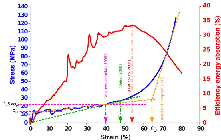
FIGURE 1.6 – Illustration des différentes méthodes d'identification du niveau de déformation à densification  $\epsilon_d$ , appliquées aux résultats d'une compression uniaxiale sur une mousse d'aluminium [**LI et collab., 2006**].
