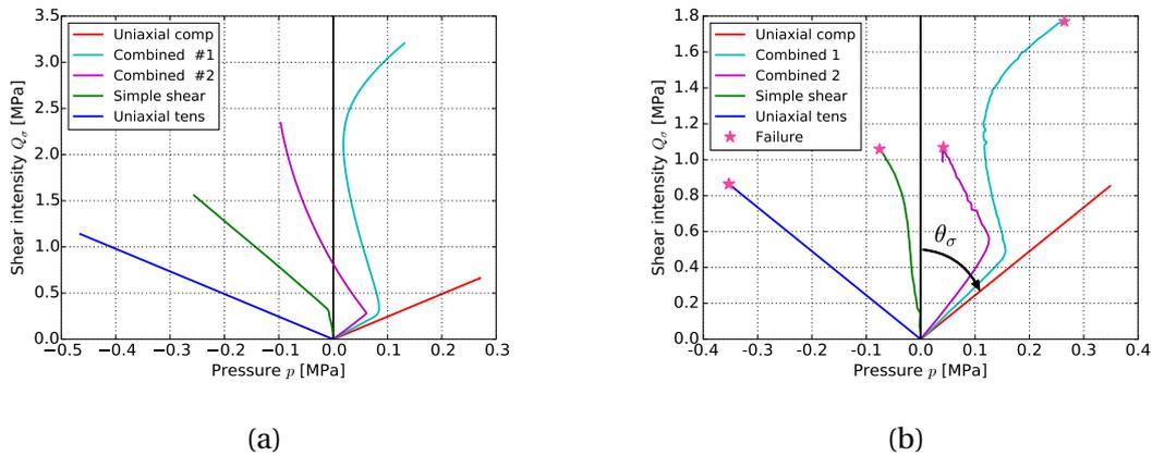
FIGURE 4.53 – Réponses en contraintes observées sur les chargements radiaux par simulation (a) et expérimentalement (b).
