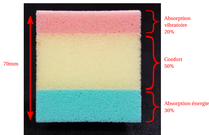
FIGURE 2.26 – Présentation des fonctions des différents matériaux présents dans les complexes testés.
