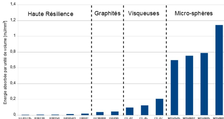
FIGURE 2.24 – Énergie dissipée par unité de masse pour chacun des matériaux testés
