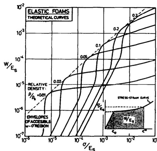
FIGURE 1.13 – Diagramme d'énergie proposé par MAITI et collab. [1984].
