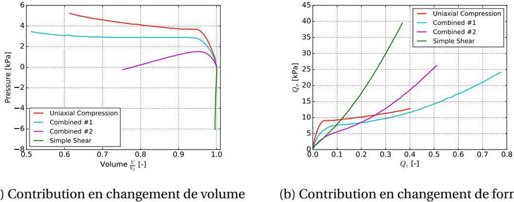
FIGURE 4.40 – Comparaison des contributions obtenues pour des chargements radiaux sur la mousse CF-47.
