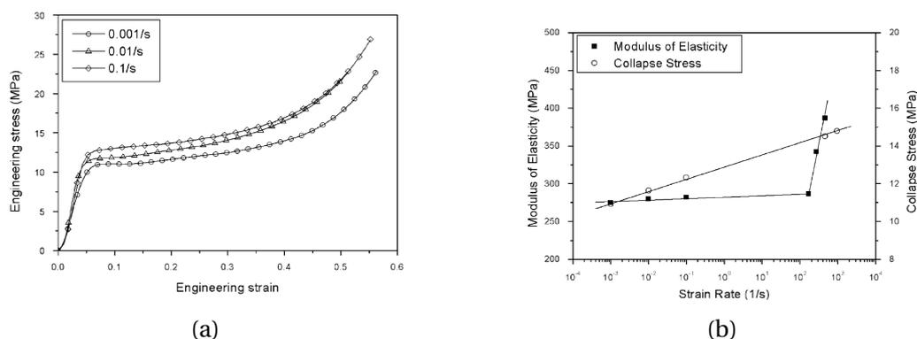
FIGURE 1.9 – Illustration de l’effet de la vitesse sur le comportement d’un matériau cellulaire polymérique (a), et tracé de l’évolution du module d’Young initial  $E^*$  (Modulus of elasticity) et de la contrainte plateau  $\sigma_{pl}$  (Collapse stress) en fonction des vitesses de déformation testées (b) [SONG et collab., 2005].
