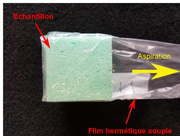
FIGURE 3.12 – Illustration du film hermétique utilisé pour envelopper les échantillons.
