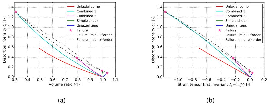
FIGURE 4.20 – Trajets radiaux obtenus par logiciel de corrélation d'images, dans le plan "intensité de distorsion  $Q_\epsilon$  - Volume  $V$ " (a), et "intensité de distorsion  $Q_\epsilon$  - premier invariant des déformations  $I_\epsilon$ " (b). Les étoiles roses représentent les ruptures des échantillons. Les courbes en pointillé définissent les limites de rupture identifiées
