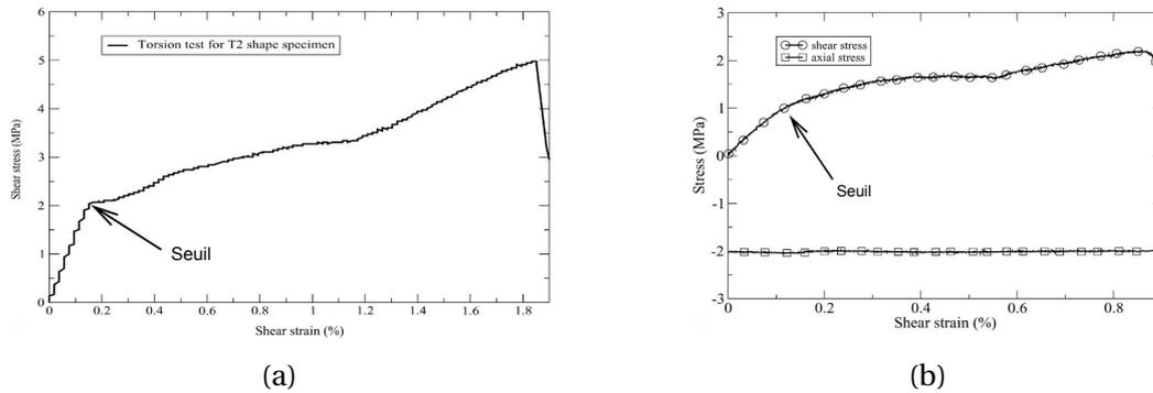
FIGURE 4.6 – Seuils de contrainte observés par BLAZY et collab. [2004] pour une sollicitation de cisaillement (a), et une sollicitation de compression suivie d'une sollicitation de cisaillement (b).
