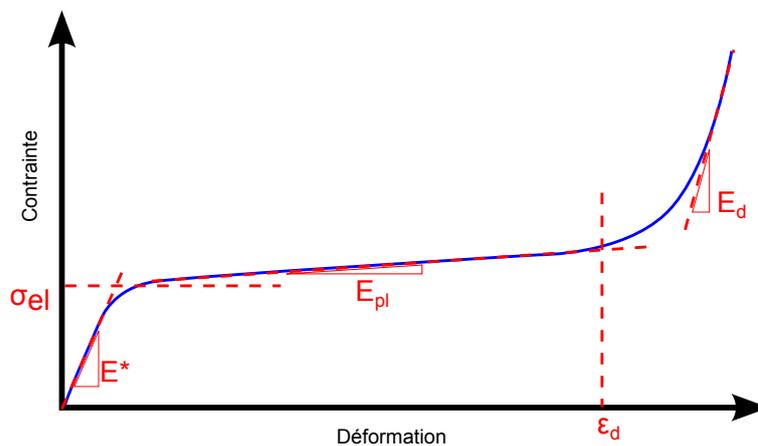
FIGURE 1.4 – Comportement typique d'un matériau cellulaire en compression uniaxiale monotone.
