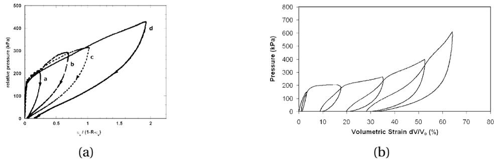
FIGURE 3.9 – Comportements en compression hydrostatique multiples obtenus par (a) MOREU et MILLS [2004] sur une mousse de polypropylène, et (b) OZTURK et ANLAS [2011] sur une mousse de polystyrène.
