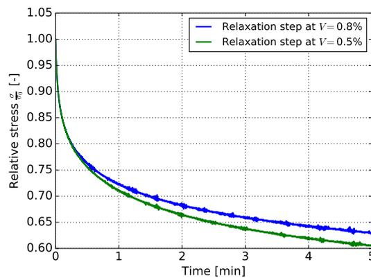
FIGURE 4.18 – Phase de relaxation après une sollicitation de compression réalisé à une vitesse de déformation  $\dot{\varepsilon}_{zz} = 0.0125s^{-1}$
