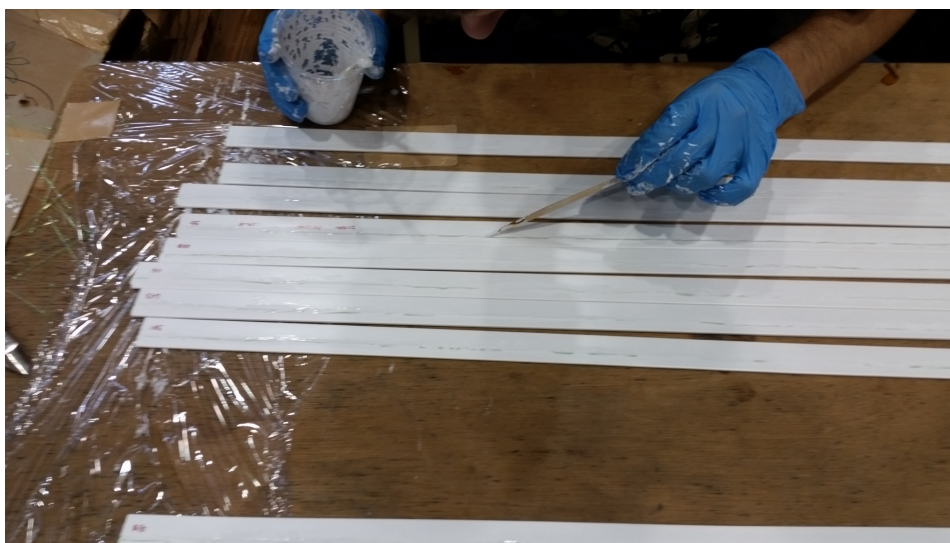
FIGURE 3.4 – Peinture du réflecteur optique au dessus du sillon dans lequel a été collé la fibre. Ici ce sont des scintillateurs sans fente pour former les plans du détecteur.
