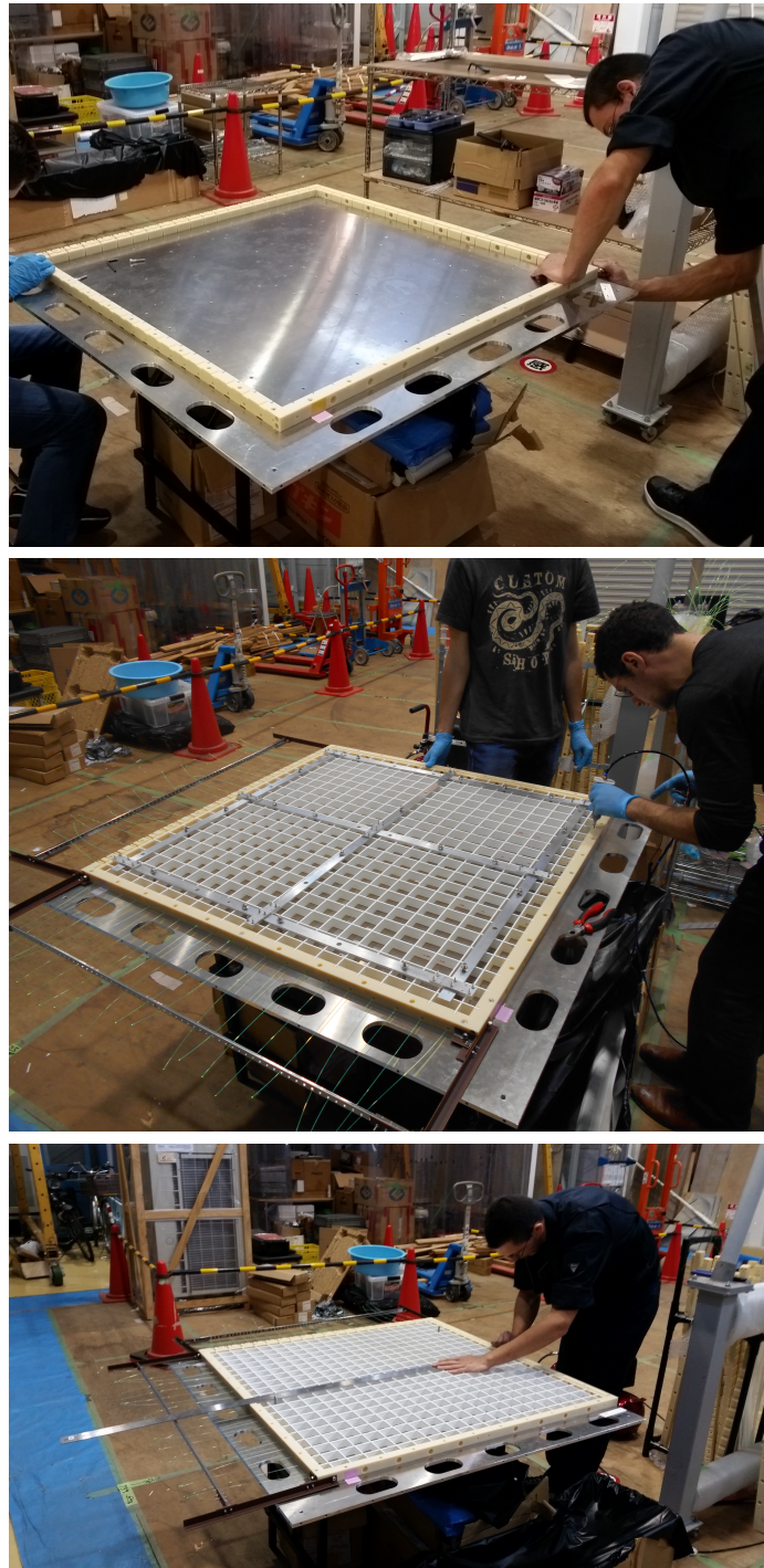
FIGURE 3.5 – Assemblage d'une grille du WaterModule, et mesure de la position des scintillateurs.
