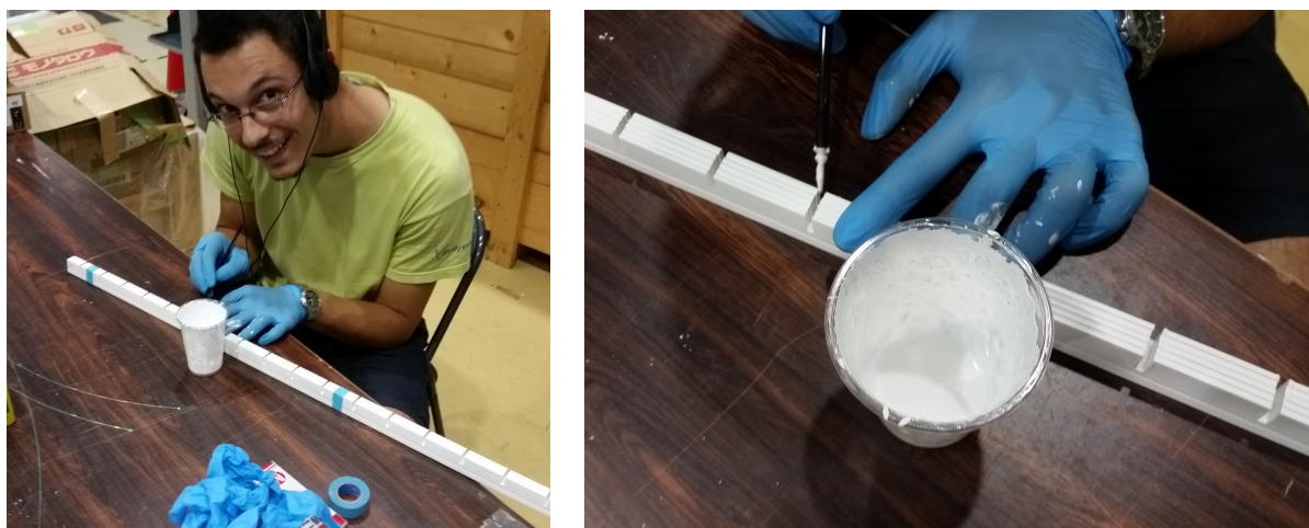
FIGURE 3.2 – Peinture du réflecteur optique dans les fentes des scintillateurs pour la grille. La couche de réflecteur sur les autres parois des scintillateurs a été déposée avant la découpe des fentes.
