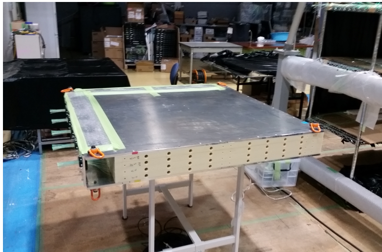
FIGURE 3.7 – Un sous-module, avant la découpe des fibres.
