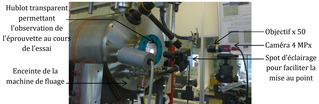
Figure 4.10 – Photo du dispositif permettant l'acquisition d'images pour la corrélation d'images.
