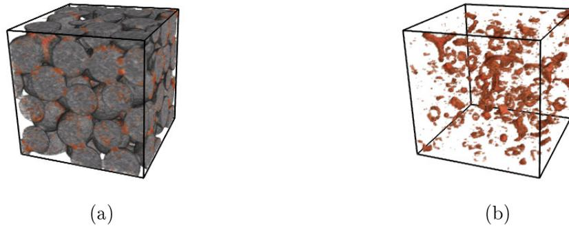
FIGURE 3.19 – Reconstruction 3D d'une partie de la cellule de taille 4x4x4 billes a) fluide et solide b) fluide uniquement.
