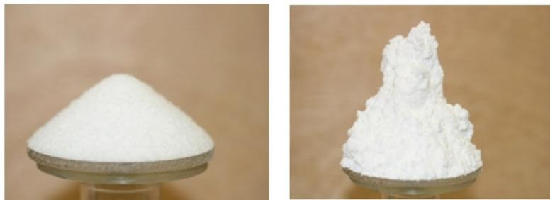
FIGURE 1.5 – Cône granulaire et adjonction de fluide : deux matériaux granulaire, à gauche un sucre sec avec des particules de diamètre 1 mm, à droite un sucre humidifié avec des particules de diamètre 50  $\mu\text{m}$ . Extrait de [68].
