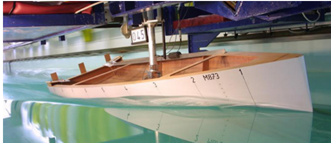
Figure 2.7 – Mesure de la résistance à l'avancement d'une carène. Image du « Wolfson Unit ».
