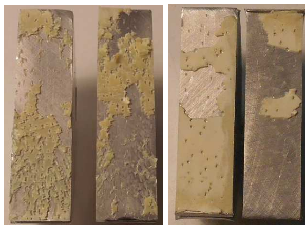
Figure III.10: Photos des surfaces de rupture : 45^\circ (gauche) et 15^\circ (droite)
