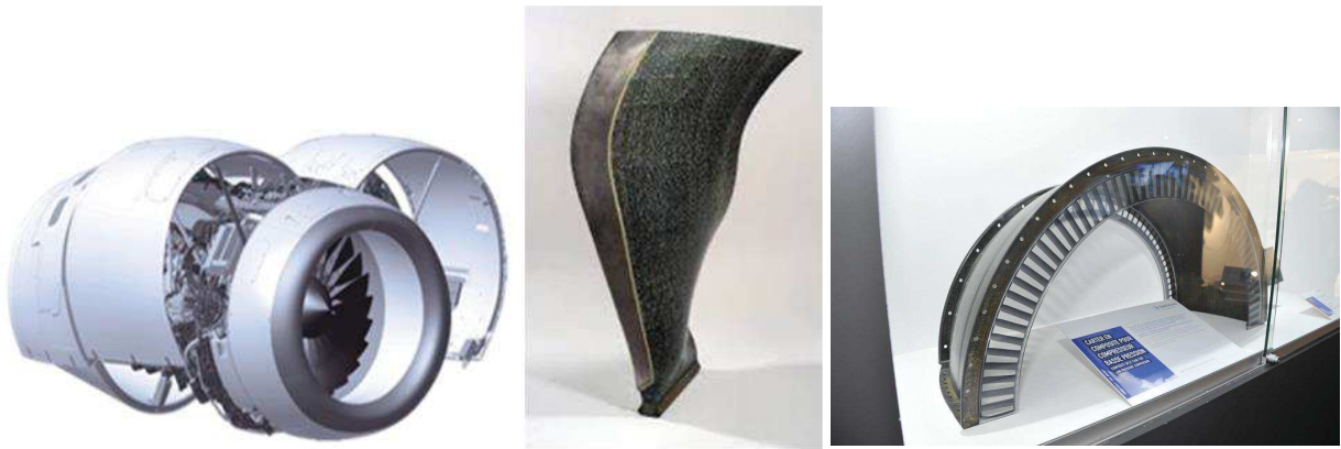
Figure 1: Différentes structures aéronautiques : Inverseurs de poussée NIDA/Peaux, Aube fan, Clinquants carter booster
