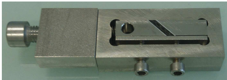
Figure VI.7: Montage de collage de l'éprouvette BIADH45
