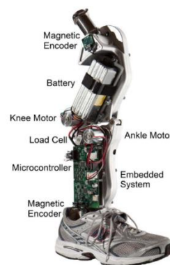
Figure I-22 — Prototype de prothèse de genou-cheville de la Vanderbilt University issu de Lawson et al. 2013)
