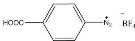
Figure II-20 : Structure du 4-carboxybenzenediazonium tétrafluoroborate
