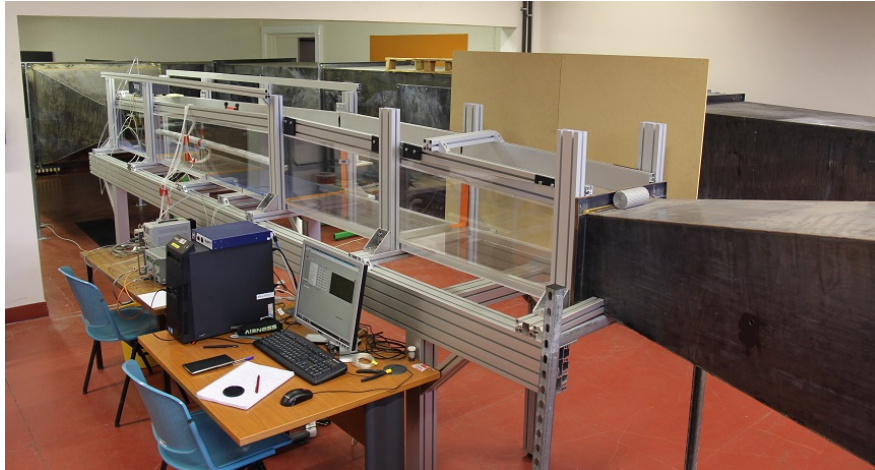
Fig. 3.1 – Vue générale de la soufflerie à retour utilisée, avec prototype de cylindre instrumenté, dans la halle de l'Unité de Mécanique de l'ENSTA ParisTech.
