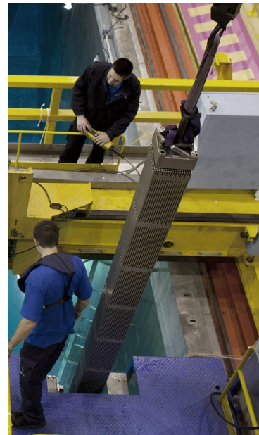
Fig. 1.3 – Assemblage combustible : (a) représentation schématisée de la structure ; (b) mise en eau, centrale de Saint-Alban ; (c) centre de formation de Chalon-sur-Saône 3 .
