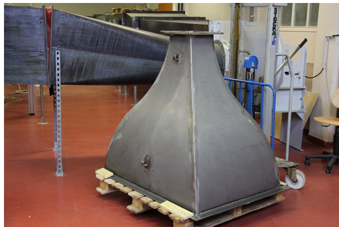
Fig. 3.3 – Livraison d'un nouveau convergent adapté aux dimensions de veine envisagées.
