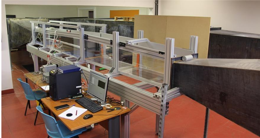
**Fig. 3.1** – Vue générale de la soufflerie à retour utilisée, avec prototype de cylindre instrumenté, dans la halle de l'Unité de Mécanique de l'ENSTA ParisTech.
