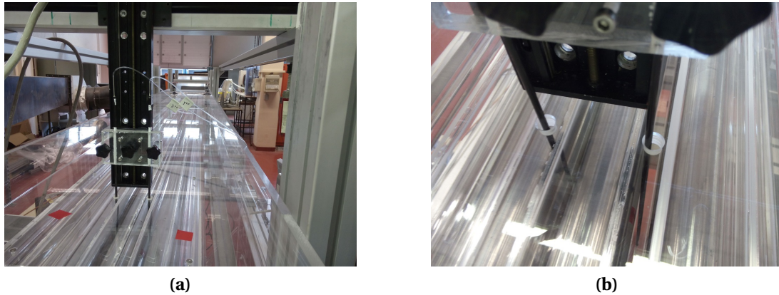
Fig. 3.13 – Prises de pression totale de part et d'autre du cylindre central en vue d'obtenir des profils de vitesse.
