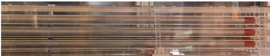
**Fig. 3.10** – Vue sur la partie aval de la maquette FICEL, cylindre central fléchi avec  $\delta \approx 6$  mm. La pointe arrière est à droite sur l'image, et est identifiée par un scotch orange, en arrière-plan du scotch rouge indiquant les cylindres périphériques. Elle est presque posée sur le cylindre inférieur ; en plus d'être fléchi, le cylindre central est donc ici translaté vers le bas, de  $P - D - \delta \approx 9$  mm.
