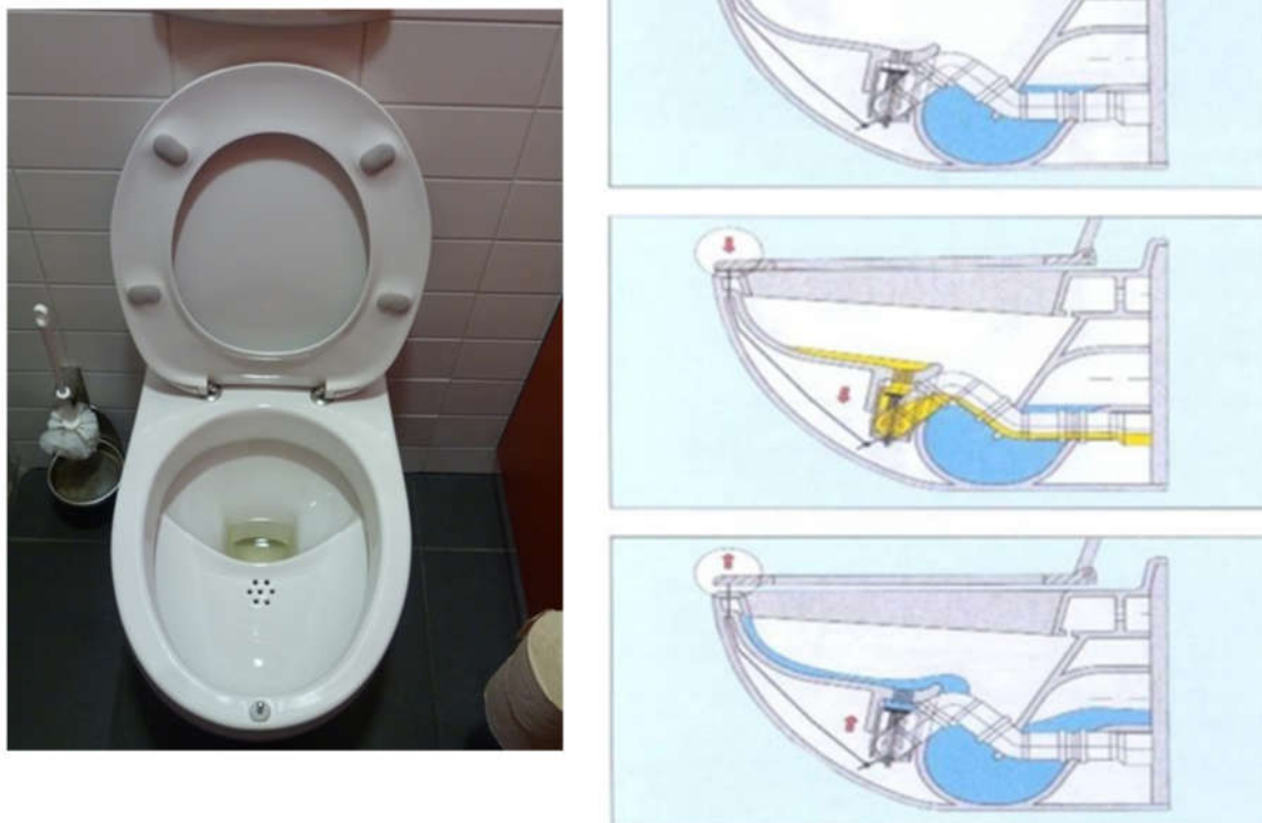
Figure 4.13 : Toilette à séparation d'urine No Mix.
