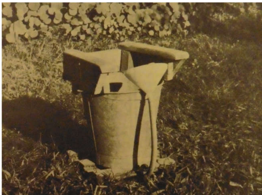
Figure 4.2 : Toilette à séparation d'urine « Séparaterre ». Développée par le Centre Culturel du Domaine de l'Étoile à Nice (France) dans les années cinquante (Trelaün, 1983)
