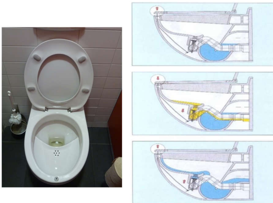
Figure 4.13 : Toilette à séparation d'urine No Mix.
