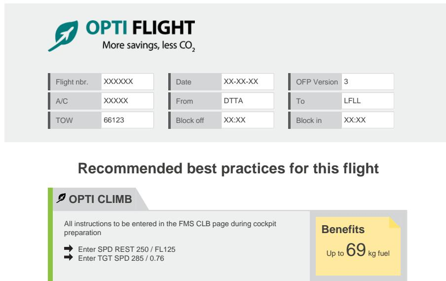
Figure 1.2 – Exemple de feuille de consigne OptiClimb. Elle indique que le pilote doit entrer dans l’ordinateur de bord une vitesse de restriction de 250 noeuds jusqu’à 12 500 pieds, et qu’il doit ensuite viser 285 noeuds, puis Mach 0,76 jusqu’au *top-of-climb* (fin de la montée). Les économies prévues sont de 69 kg de carburant ici.
