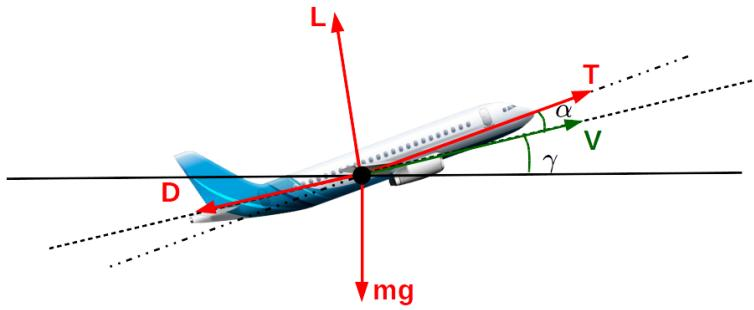
Figure 1.6 – Illustration de la dynamique d'un avion en montée.
