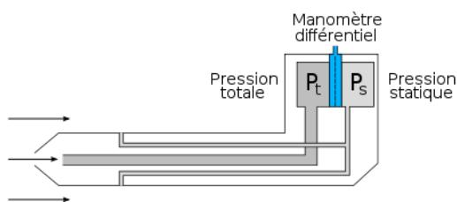
Figure 1.4 – Fonctionnement d'une sonde de Pitot.<sup>11</sup>
