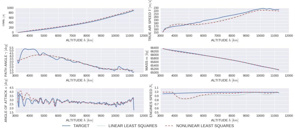
Figure 1.7 – Resimulation d'un vol réel (bleu) en utilisant les dynamiques estimées par des moindres carrés linéaires (vert) et non linéaires (rouge).
