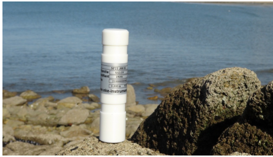
FIGURE B.7 : Capteur de température de l'eau nke instrumentation monté sur les chaînes latérales immergées dans le lac de Créteil ( http://www.nke-instrumentation.fr )
