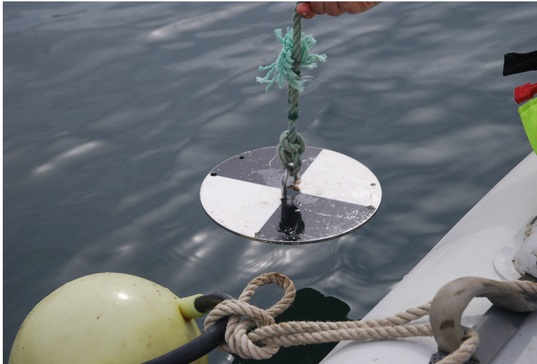
FIGURE B.10 : Disque de Secchi utilisé au lac de Crêteil (José Rodolfo scarati Martins)
