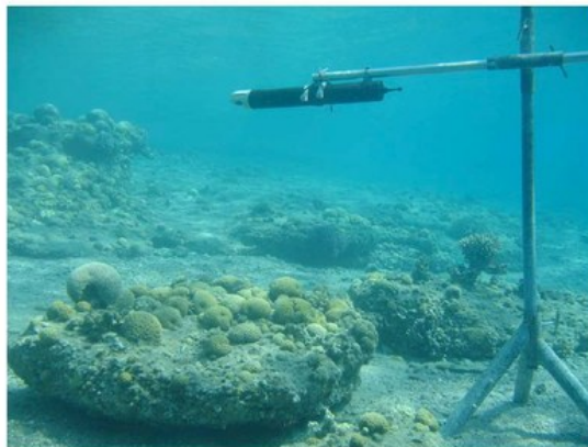
FIGURE B.9 : Profileur de vitesse Nortek à effet Doppler haute résolution immergé dans le lac de Créteil ( http://www.nortek-as.com )
