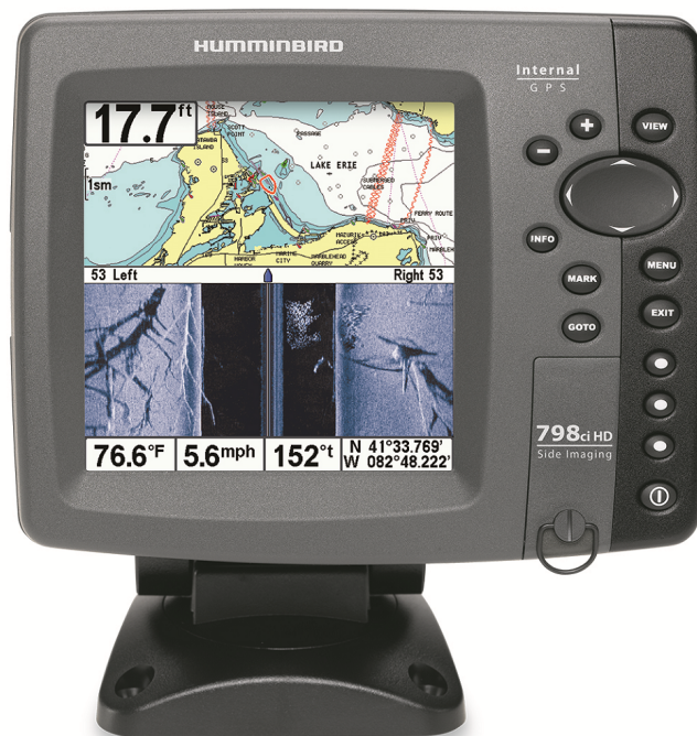
FIGURE B.11 : Echosondeur Humminbird 798ci HD SI Combo utilisé au lac de Crêteil ( https://www.humminbird.com )
