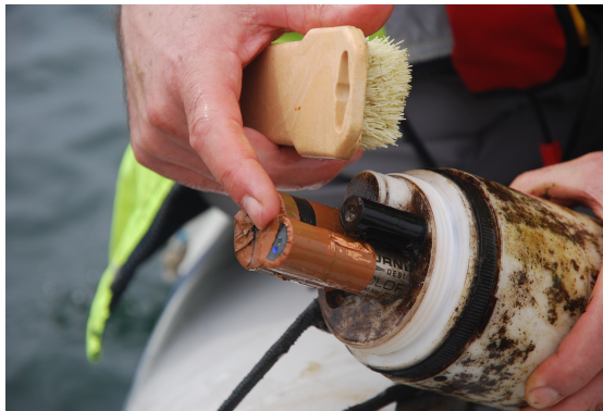
FIGURE B.8 : Sonde multiparamètres nke instrumentation montée sur les chaînes latérales immergées dans le lac de Créteil (José Rodolfo scarati Martins)
