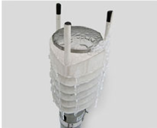
FIGURE B.2 : Capteur météorologique multiparamètres Vaisala WXT520 monté sur la station du lac de Créteil ( http://www.vaisala.com )
