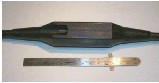
FIGURE B.4 : Capteur de température de l'eau Precision Measurement Engineering, Inc. monté sur la chaîne de mesure de la station du lac de Créteil ( http://www.pme.com )
