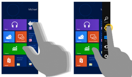
FIGURE 5.5 – Exemple de menu caché qui peut-être affiché avec un geste initié depuis le contour du dispositif (source [135]).
