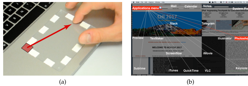
FIGURE 6.1 – (a) Exemple d'un geste MarkPad effectué en glissant son doigt d'une zone de départ à une zone d' arrivée . (b) Interface graphique affichée en mode novice , représentant ici le menu ouvert par l'utilisateur en effectuant le geste montré dans (a).
