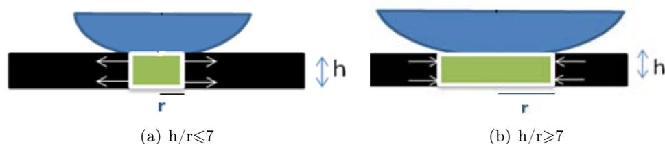
FIGURE 5.1 – Les deux types de configuration entre le minerai et l'élastomère : (a) compression uniaxiale, (b) compression œdométrique.
