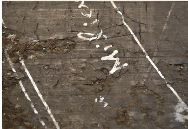
FIGURE 6.9 – Détérioration prononcée de la partie centrale de la bande.
