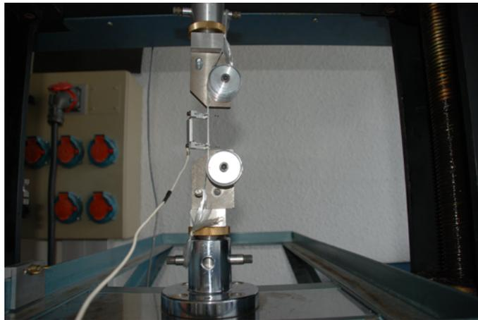
FIGURE 5.2 – Dispositif expérimental pour un essai de traction uniaxiale sur fil.
