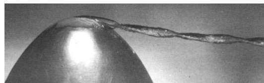
(b) Tourbillon marginal en bout d’un profil Naca 66 2 – 415 ( Re = 5.3 \times 10^5 ; \sigma = 0.58 ; \alpha = 9.5^\circ ). Source : [ARNDT et al., 1991] .
