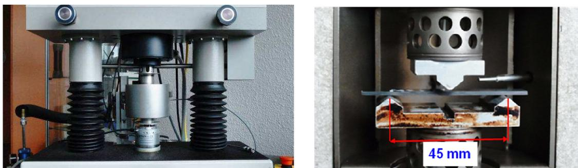
Figure III.30 - Dispositif de la DMTA et géométrie des éprouvettes
