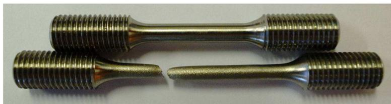
Figure IV.3 - Eprouvettes saine et après rupture
