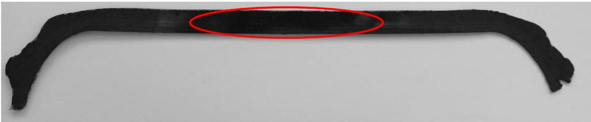
Figure V.21 - Echantillon polis : zone d'analyse du taux volumique de fibres
