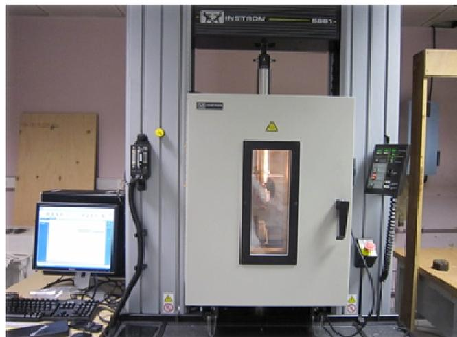
Figure IV.8 - Dispositif expérimental de traction
