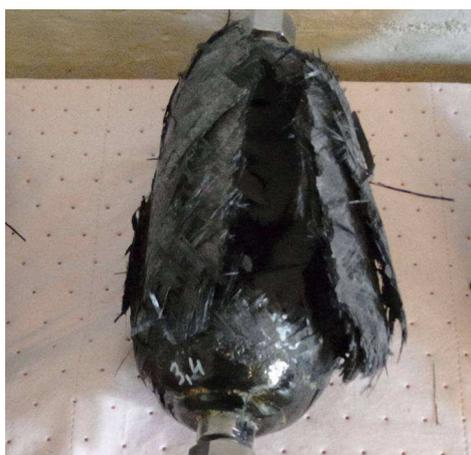
**Figure VII.20** - Réservoir éclaté et zone d'éclatement
