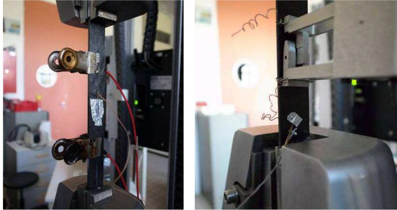
Figure III.7 - Thermocouples à la surface des éprouvettes
