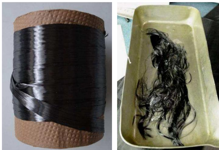
**Figure III.1** - Mèche de fibres de carbone T700sc
