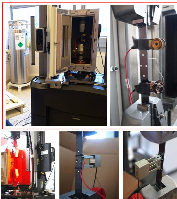
**Figure III.6** - Dispositif expérimental de traction
