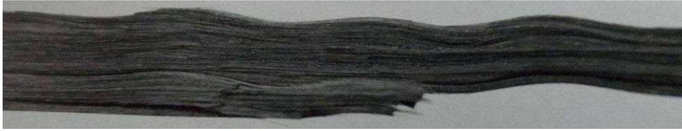
**Figure III.15 - Fibres ondulées**
