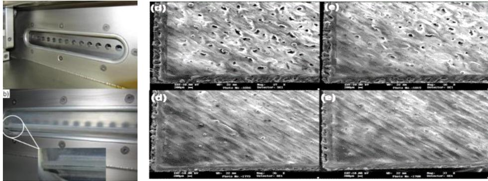
**Figure I. 52 : Diminution des porosités ouvertes avec la focalisation de la fente d'entrée d'argon. (a) Montage (b) Surfaces de construction (Ti6Al4V) pour différentes densités d'énergie (d : 0.70 J/mm, e : 0.80 J/mm) avec une vitesse d'Ar (faible en haut, élevée en bas) (Kong, 2011).**
