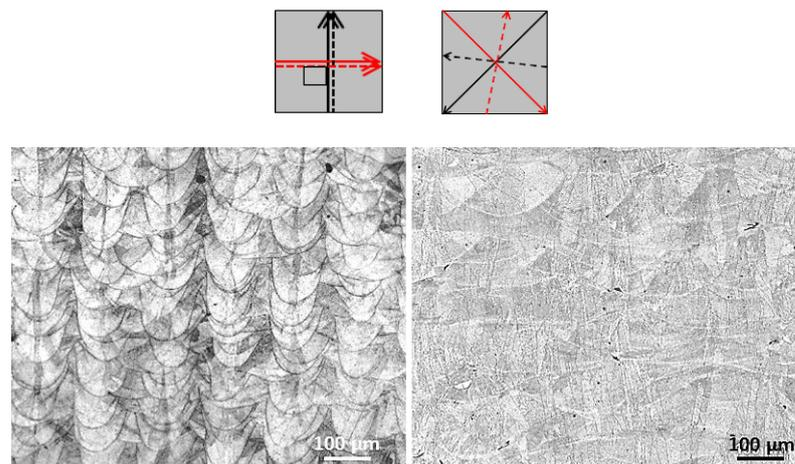
Figure IV. 3 : Micrographies de coupes transverses fabriquées avec une (a) stratégie croisée avec un angle de balayage fixé à  $90^\circ$  (b) stratégie multi-angulaire.
