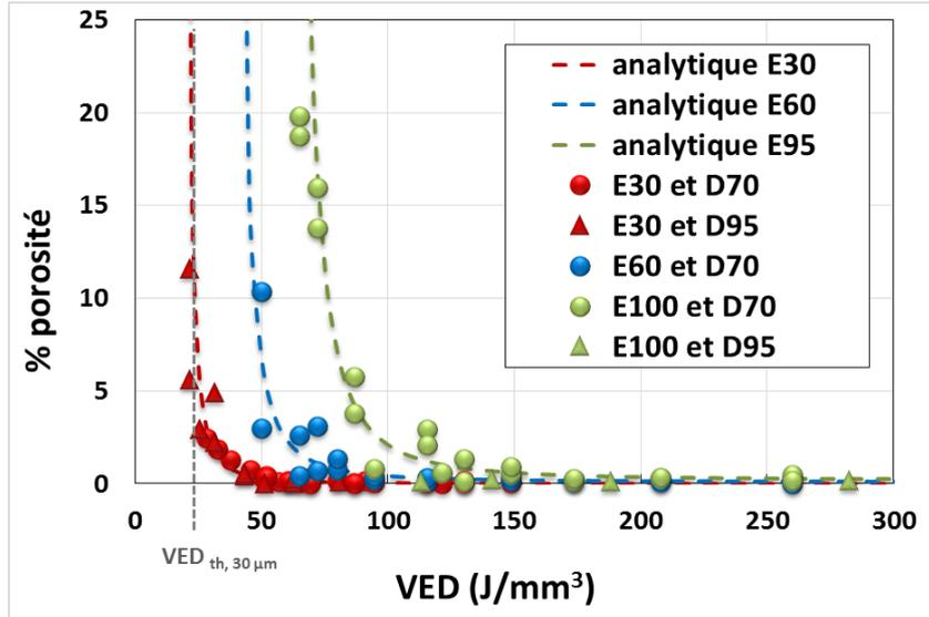
Figure IV. 25 : Modèle analytique et résultats expérimentaux.
