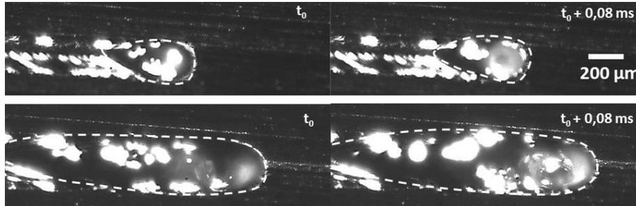
Figure III. 7 : Essais de fusion pleine tôle (V330\_D200\_E60\_C2) pour a) 320W (b) 750 W.
