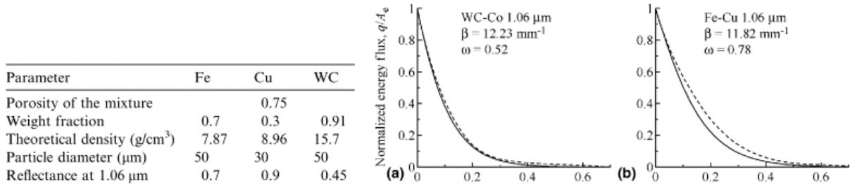
**Figure I. 19 : Extinction du rayonnement laser à 1.06 μm pour différents mélanges de poudres métalliques (calcul par lancer de rayons (pointillé) ou modèle équivalent (solide)) (Gusarov, 2005).**
