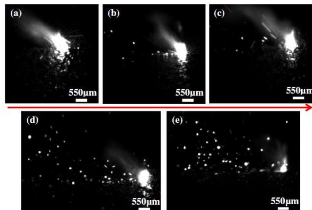
**Figure I. 69 : Images des éjections en caméra rapide (400 W - 2.4 m/s) pour cinq épaisseurs de couches (a) 20 μm, (b) 40 μm, (c) 60 μm, (d) 80 μm, (e) 100 μm. La flèche rouge représente la direction de balayage. La dynamique d'éjection augmente avec l'épaisseur (Qiu, 2015).**
