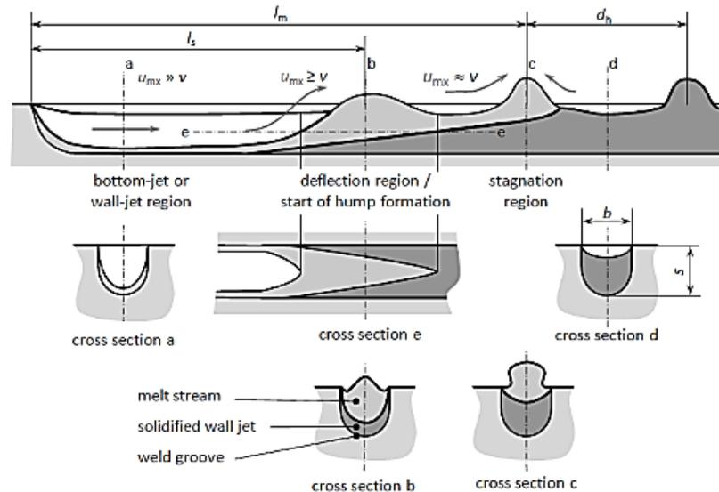
Figure I. 32 : Observation de la formation des humps (Berger, 2011).
