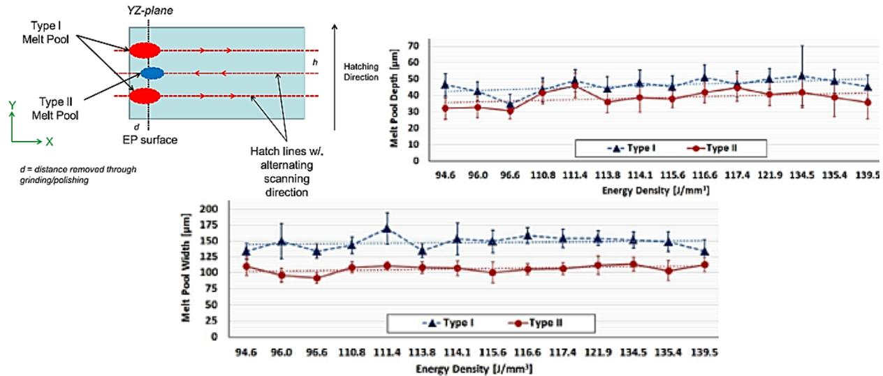
**Figure I. 35 : Etude des géométries sur poudre In 625. (a) Distinction entre les cordons proches (type I) ou non (type II) de la ZAT du lasage précédent (b) et (c) La largeur est plus sensible à la ZAT que la profondeur (Criales, 2017).**
