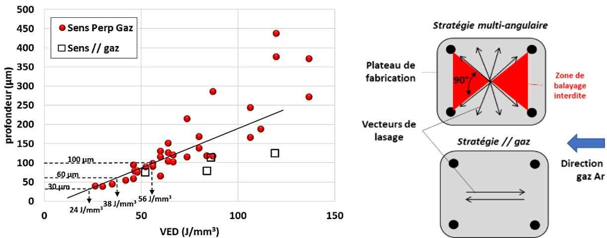
Figure IV. 30 : (a) Effet des directions de lasage sur les profondeurs fondues (les seuils de début de densification pour les trois épaisseurs de couches utilisées sont également représentés) (b) Plage angulaire interdite par défaut dans la stratégie de lasage.
