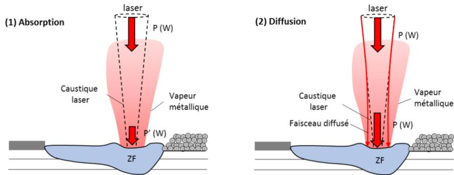
Figure IV. 28 : Interaction laser/vapeur métallique. Deux mécanismes qui peuvent diminuer la densité de puissance déposée ( $W/cm^2$ ) à la surface de la ZF : (a) l'absorption du laser : la puissance transmise  $P' < P$  initiale, (b) la diffusion du rayonnement qui fait diverger le faisceau et augmente le diamètre d'interaction.
