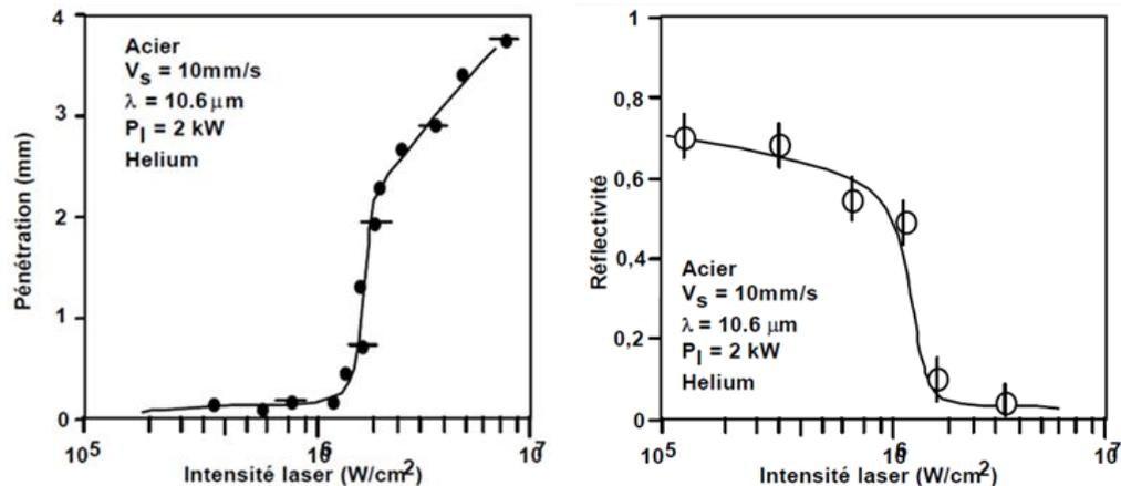
Figure I. 22 : Transition conduction - keyhole sur acier avec un laser CO<sub>2</sub>. Evolution de la pénétration des cordons de soudage et de la réflectivité du matériau en fonction de l'intensité laser (Fabbro, 2010).
