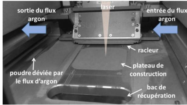
Figure III. 55 : Evacuation des éjectas au niveau de la machine SLM.
