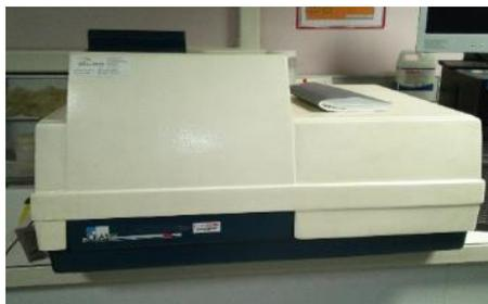
Figure II. 17 : Granulomètre CILAS 920L (voie liquide).
