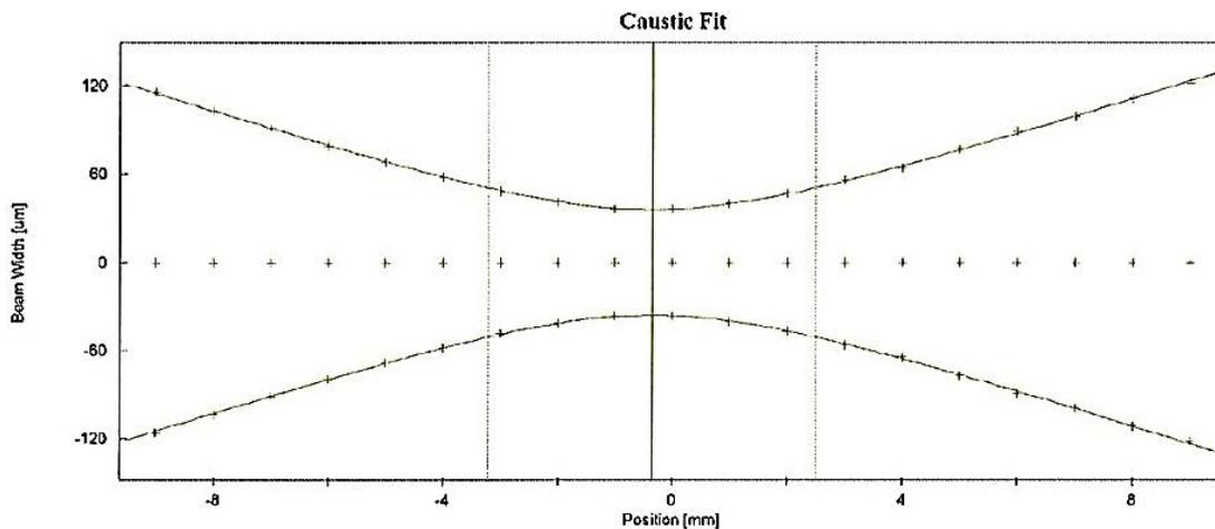
Figure II. 2 : Caustic du faisceau laser sur la machine SLM.
