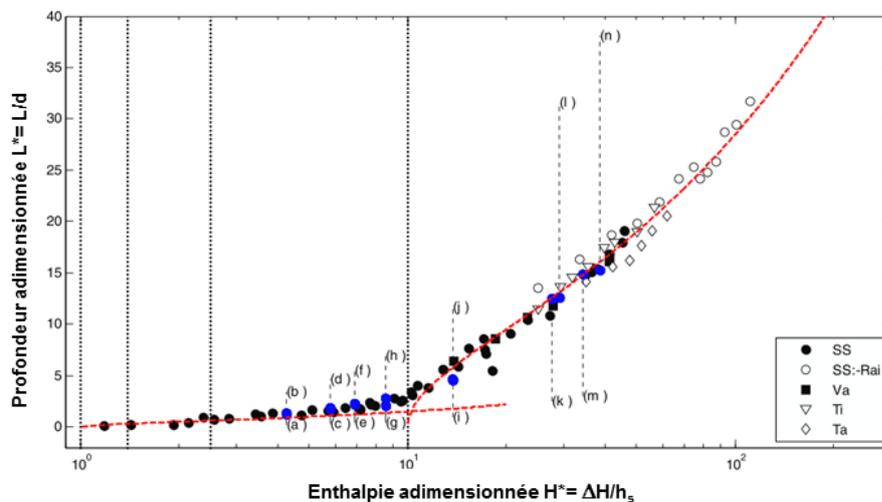
**Figure I. 26 : Calcul des profondeurs adimensionnées de soudage en fonction du rapport enthalpique  $\Delta H/\Delta H_s$  (Hann, 2011) et validation sur différents matériaux (la transition de pente à  $\Delta H=10 \cdot \Delta H_s$  correspond à l'enthalpie de vaporisation et au seuil de formation du keyhole).**
