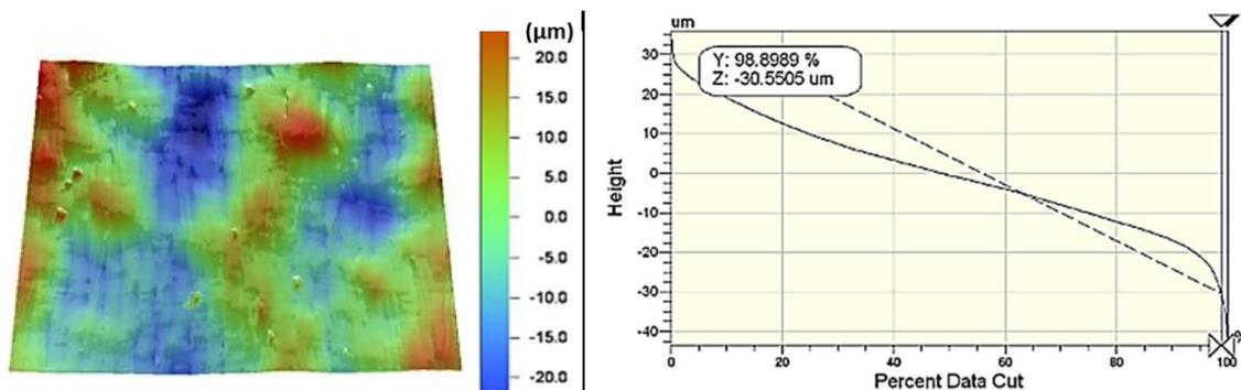
Figure IV. 42: (a) profil 3D d'une surface (b) % de surface totale inférieure à 30 µm.
