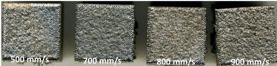
Figure IV. 39 : Surface de fabrication d'une pièce élaborée à différentes vitesses (P175\_H120\_croisée).
