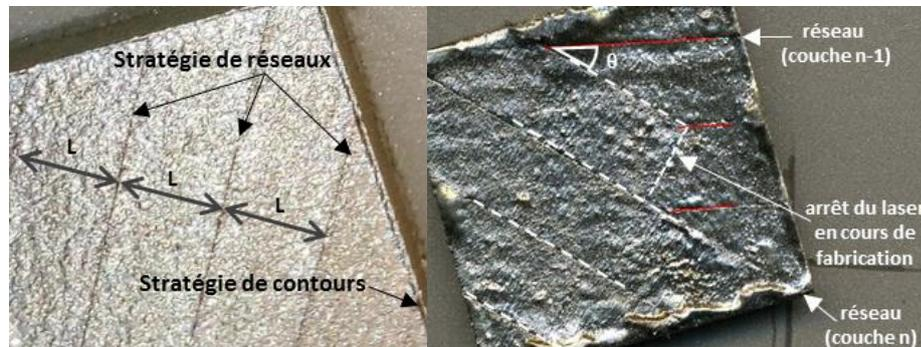
Figure IV. 19: (a) Système de stratégie en réseaux (P250\_V900). (b) Accentuation des irrégularités créées par ces réseaux avec le mauvais choix de paramétrage (P400\_V900\_D70).
