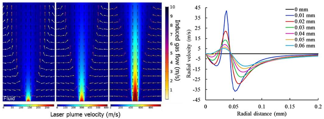
**Figure I. 75 :** Simulation numérique des vitesses de colonnes de vapeur et de gaz induits. (a) Représentation 2D des vitesses pour des puissances croissantes. (b) Vitesses radiales d'Ar conduisant à la dénudation, en fonction de la distance (Bidare, 2018).
