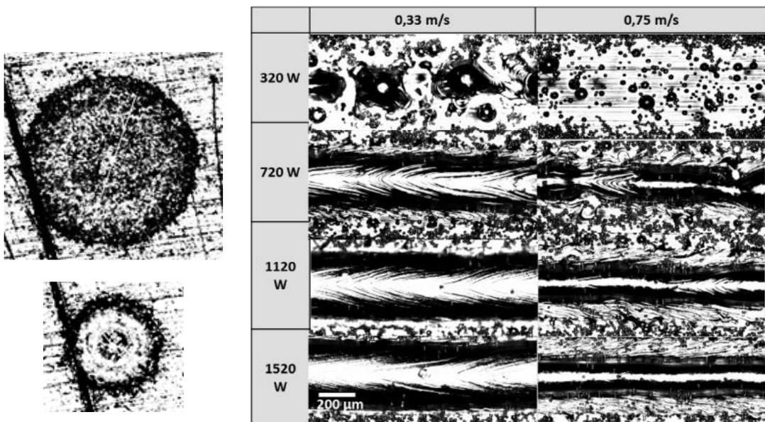
Figure IV. 46 : (a) Diamètres 600  $\mu\text{m}$  et 200  $\mu\text{m}$  lors de tirs statiques, (b) Morphologies de cordons fabriqués à D600 ( $2 \text{ J}/\text{mm}^3 < \text{VED} < 16 \text{ J}/\text{mm}^3$ ).
