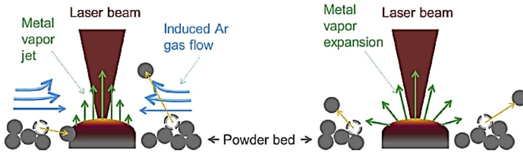
**Figure I. 72 : Mécanisme de dénudation. (a) A fortes pressions, la colonne de vapeur métallique à grande vitesse crée une dépression à la surface de la zone fondue et induit un flux d'Ar latéral centripète par effet Bernoulli, entraînant la poudre dans le bain liquide. (b) A faible pression, l'expansion de la colonne de vapeur pousse les particules vers l'extérieur (Matthews, 2016).**
