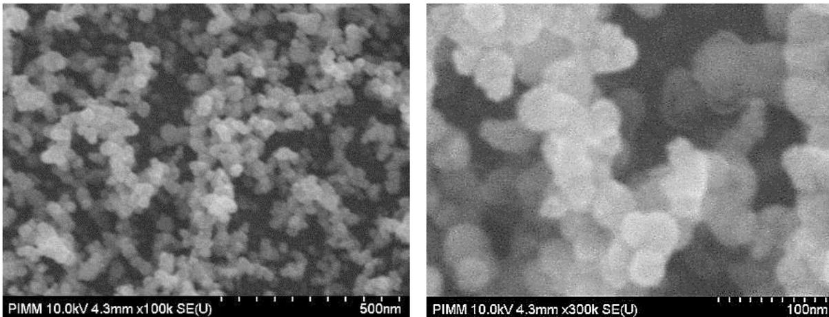
Figure III. 54 : Nano condensats (20 nm) (P320\_V330\_D200\_E65).
