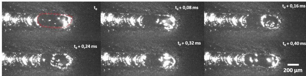
**Figure III. 79: Images vidéo successives (12500 im/s) sur Al 4047. Bain liquide stable (P720\_V330\_D200\_E60\_C2).**
