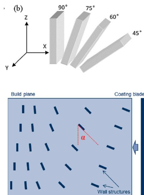
**Figure I. 11 : (a) Inclinaison des pièces pour minimiser le nombre de couches et le temps de fabrication (Krauss, 2013) (b) Positionnement des pièces sur un plateau : inclinées par rapport à la direction d'étalement pour ne pas endommager le racleur (Shifeng, 2014).**
