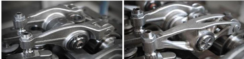
**Figure I. 2 : Culbuteur moteur Renault Euro 6 DTI5 (a) Version originale (b) Version après reconception par fabrication additive avec moins 25 % de la masse initiale (Metal Additive Manufacturing, 2017).**
