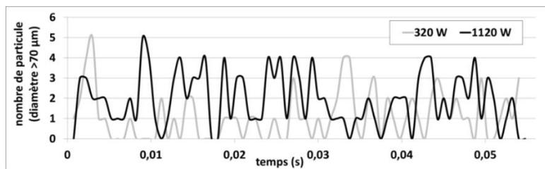
**Figure III. 51 :** Evolution temporelle du nombre d'éjections de diamètre > 70 µm pour deux puissances sur 73 images (V750\_D200\_E60).
