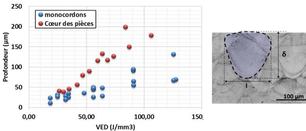
**Figure III. 40 : (a) Profondeurs de fusion obtenues sur mono-cordons comparées à celles mesurées au cœur des pièces (b) dimensions considérées (ici machine SLM, D= 70 µm).**
