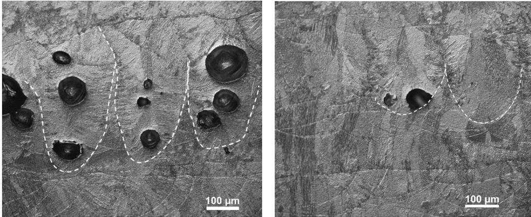
**Figure IV. 44 : Pores piégés en bord de pièce. Mise en évidence d'un régime de keyhole à VED élevé (260 J/mm<sup>3</sup>).**
