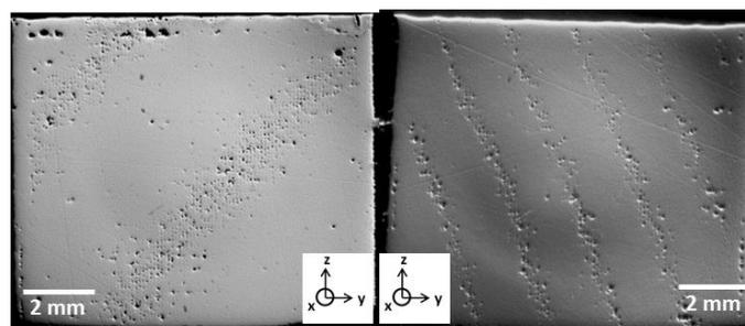
Figure IV. 20 : La stratégie de réseaux et la combinaison des autres éléments de balayage par couche peuvent mener à des alignements de porosités en diagonale.
