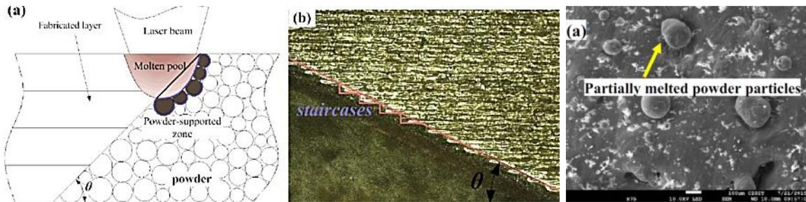
Figure I. 59 : (a) L'inclinaison de la pièce et (b) l'effet escalier (Liu, 2017) et (c) les éjectas (Wang, 2017) jouent un rôle sur la rugosité des surfaces inférieures (downskin).
