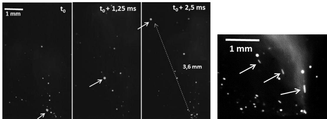
**Figure III. 45 :** (a) Suivi de particules éjectées (diamètre de 120  $\mu\text{m}$ ) : 3.6 mm sont parcourus en 2,5 ms soit  $V \approx 1.44 \text{ m/s}$  (b) Particules de diamètre 30-50  $\mu\text{m}$  : 200  $\mu\text{m}$  sont parcourus en 1/160 000 s soit  $V \approx 31 \text{ m/s}$  (P520\_V330\_D200\_E60\_B).
