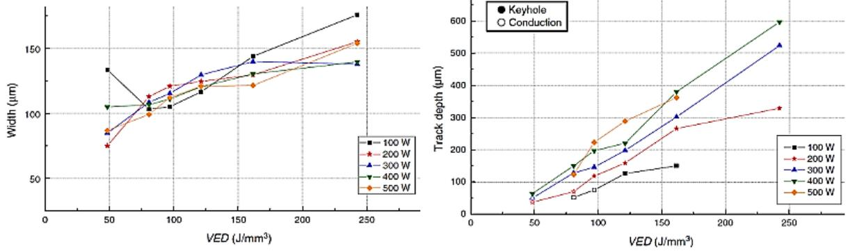
**Figure I. 36 : Utilisation d'un VED en fonction de (a) la largeur et (b) de la profondeur. Le VED décrit mieux l'évolution de la largeur du mono-cordon que celle de la profondeur (Scipioni Bertoli, 2017).**
