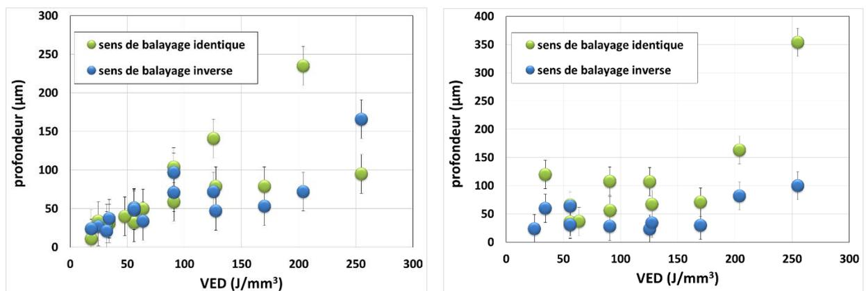
**Figure III. 78 : Influence du sens de lasage sur la géométrie des cordons (a) pleine tôle (b) lit de poudre de  $120 \mu m$  (Machine SLM, D100).**
