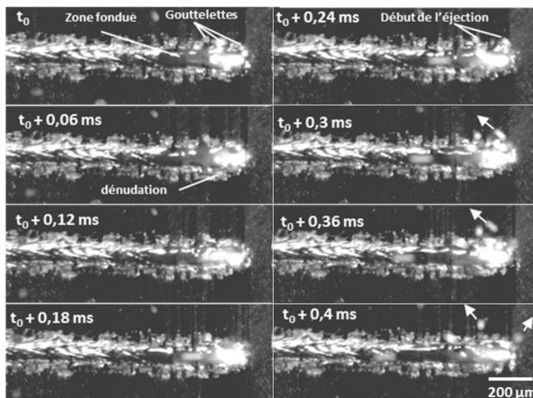
Figure III. 9 : Images vidéo (16000 im/s) des zones fondues avec un diamètre de faisceau  $D= 100 \mu\text{m}$  (P450\_V540\_E50\_C3) (largeur de fenêtre = 1.5 mm).
