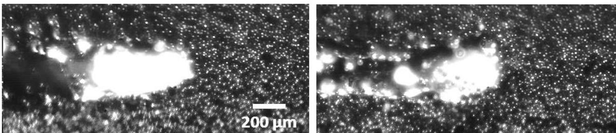
Figure III. 6 : Fusion sur lit de poudre (P1520\_D200\_E60\_C2). Différence de régimes pour deux vitesses (a) 330 mm/s (b) 750 mm/s.
