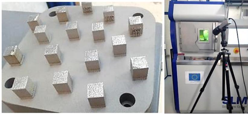
**Figure II. 3 : Exemples de données récupérées à partir de la machine : (a) pièces SLM (cubes de 10 x 10 x 10 mm) (b) observation de l'interaction laser-lit de poudre à partir d'une caméra rapide située à l'extérieur de l'enceinte.**
