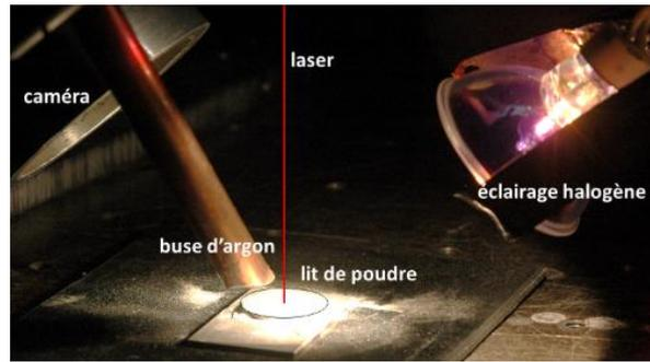
Figure II. 5 : Configuration utilisée pour les essais statiques.
