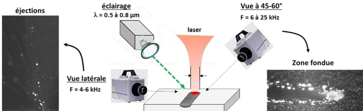
Figure II. 6 : Principe du banc instrumenté avec les deux configurations d'analyse (latérales pour étude des éjections et inclinée à 45-60° pour étude des ZF).
