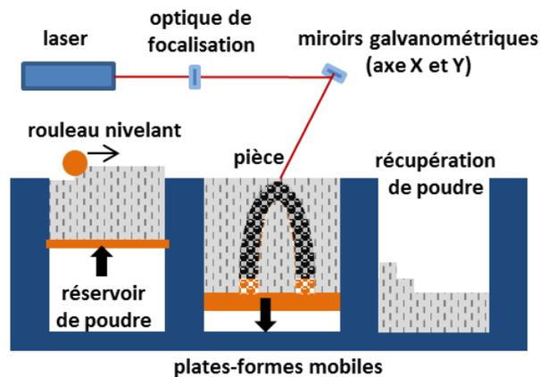
Figure I. 9 : Schéma du fonctionnement du procédé SLM.
