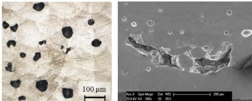
**Figure I. 38 : (a) Porosités sphériques liées à la présence de gaz occlus (Kasperovich, 2016) (b) pore non sphérique lié à une mauvaise dilution inter-couches et à une mauvaise optimisation des paramètres opératoires (Aboulkhair, 2014).**
