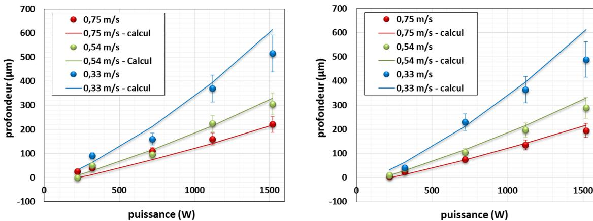
**Figure III. 42 : Calcul analytique ( $m \approx 5$  et  $n \approx 5$ ) des profondeurs fondues sur banc instrumenté (D200) en (a) fusion pleine tôle et (b) avec 60 µm de poudre.**
