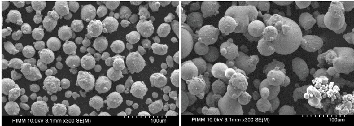
Figure III. 57 : Images MEB (a) poudre initiale de 15 à 45  $\mu\text{m}$  (b) poudre évacuée par le racleur.
