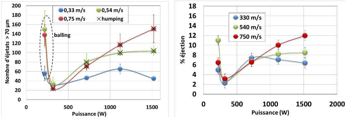
**Figure III. 50 :** (a) Evolution du nombre de grosses particules avec la puissance. Les cas présentant une oscillation verticale des ZF (proche du humping) sont représentés par des croix (b) Evolution du % ejection ( $S_{\text{ejection}}/ S_{\text{totale analysée}}$ ) avec la puissance (D200\_E60) (33 images).
