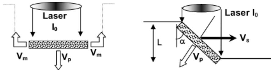
Figure I. 24 : Modèle du piston: (a) configuration statique (cas du perçage), (b) avec déplacement relatif du métal irradié (cas du soudage) et inclinaison du capillaire d'un angle  $\alpha$  par rapport à la normale.
