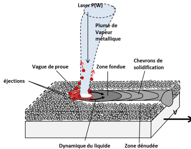
**Figure III. 10 : Description schématique de la fusion SLM.**
