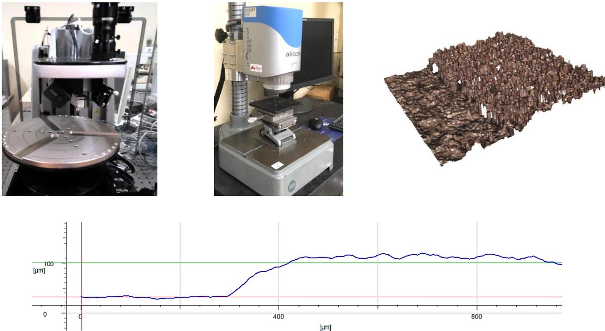
**Figure II. 18 : (a) Profilomètre mécanique VEECO Dektak Stylus 150 (b) Profilomètre optique 3D Alicona Infinite FocusSL (c) Résultats obtenus par Alicona d'un lit de poudre de 100  $\mu\text{m}$  (d) Profil 1D correspondant.**
