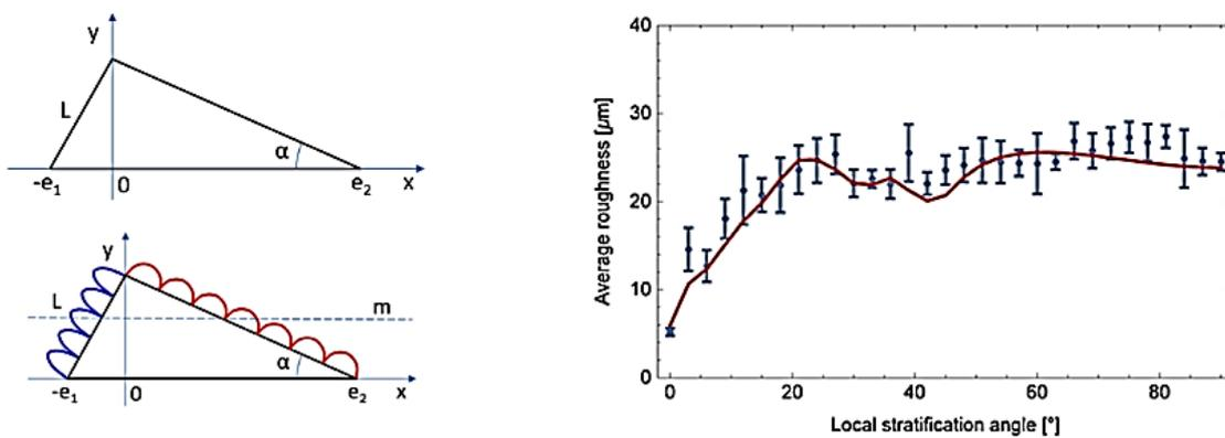
Figure I. 60 : Modèle de simulation permettant de prédire la rugosité. (a) Marche d'escalier unitaire avec et sans ajout des zones fondues-particules agglomérées, (b) Résultat du calcul (Boschetto, 2017).
