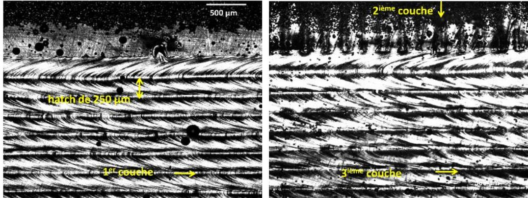
Figure IV. 49 : Vue de dessus d'une structure composée de 15 cordons sur trois couches à D600 (P640\_V200\_H250) (a) première couche fondue, (b) deuxième couche partiellement recouverte par la 3ème couche.
