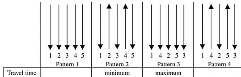
Figure I. 13 : Quatre configurations (variation du sens et de l'ordre de lasage) possibles. Le cas *Pattern 3* correspond à un temps de lasage maximum (Olanmi, 2015).
