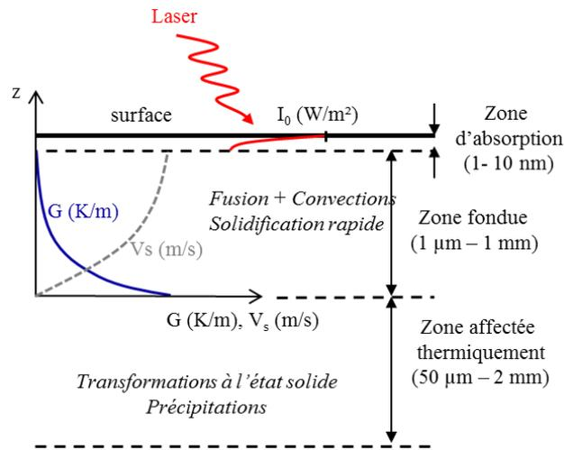
**Figure I. 18 : Absorption d'un rayonnement laser par une surface métallique, états de la matière et grandeurs thermiques associées (gradient thermique  $G$  (K/m), vitesse de solidification  $V_s$  (m/s)) (Peyre, 2012).**
