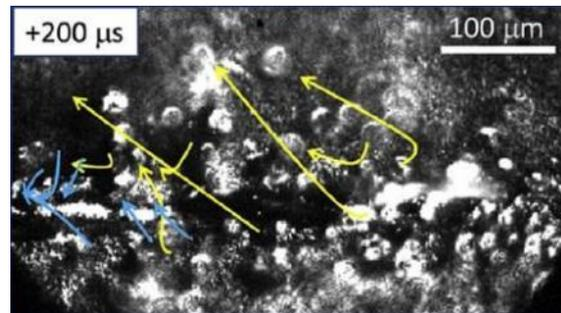
**Figure I. 73 : Mouvements de particules autour de la zone fondue (en bleu : particules attirées vers la ZF, en jaune, particules éjectées) (Matthews, 2016).**
