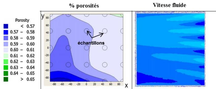
**Figure I. 53 : Corrélation entre écoulement gazeux dans la chambre (à droite, calculé sous Fluent) et taux de porosités (Ferrar, 2012).**
