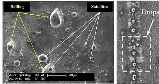
**Figure I. 66 : (a) Balling au niveau d'une surface SLM (Aboulkhair, 2016). (b) Balling au niveau d'un mono-cordon (Yadroitsev, 2007).**
