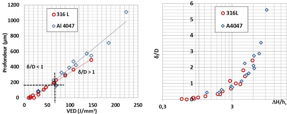
Figure III. 90: (a) Profondeurs fondées sur 316L et Al4047, (b) Rapport de pénétrations ( $\delta/D$ ) en fonction de la valeur de l'enthalpie normalisé  $\Delta H/\Delta H_s$  selon l'approche de Hann (2011) (banc instrumenté, D200\_E60).
