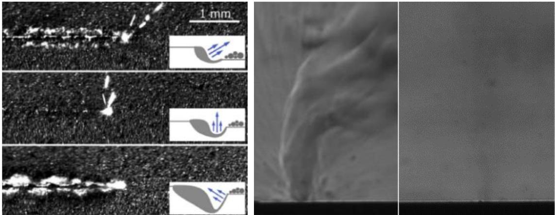
**Figure I. 74 :** (a) Images SLM 50 W-0.1 m/s, 100 W-0.5 m/s et 200 W-1 m/s (de haut en bas). L'augmentation de P et V incline la colonne vers l'arrière et renforce la dénudation. (b) Images Schlieren des colonnes de vapeur sous Ar (avec cross-jet latéral) et sous He respectivement (Bidare, 2018).
