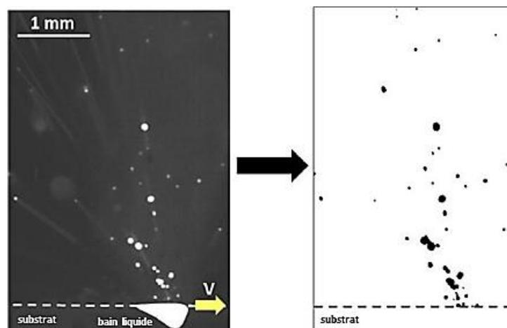
**Figure II. 8 : Traitement sur Image J. Définition des zones saturées et génération d'une image binarisée à partir des vidéos d'éjectas.**
