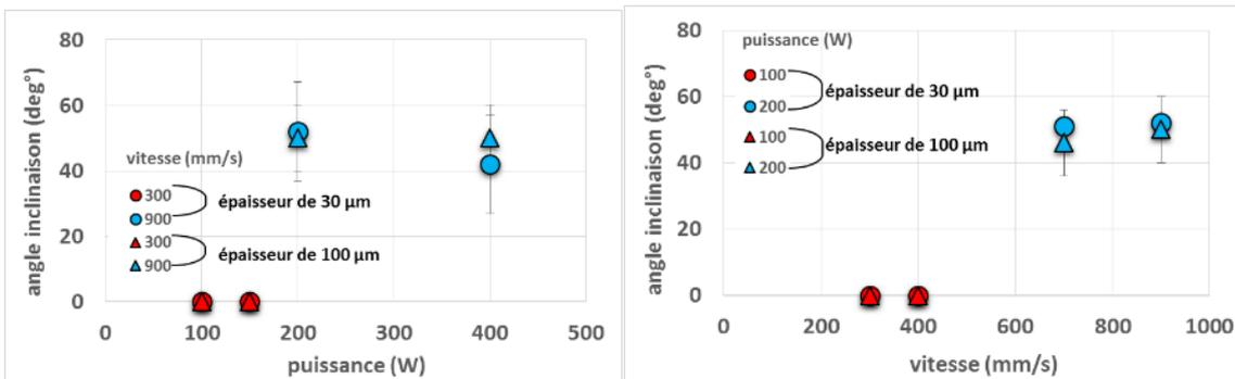
Figure III. 75 : Mesure des angles inclinaison  $\theta$  pour le sens balayage laser/ Flux d'argon identique ( $\leftarrow$  et  $\leftarrow$ ) (a) influence de la puissance (b) influence de la vitesse.
