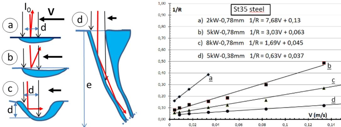
**Figure I. 25 : (a) Modèle de Fabbro (2017) : Lorsque la profondeur fondue > au diamètre du faisceau, les rayons laser sont dirigés vers le bas et le keyhole peut se former. (b) Application du modèle au calcul des profondeurs adimensionnées  $1/R$  en fonction de la vitesse de soudage.**
