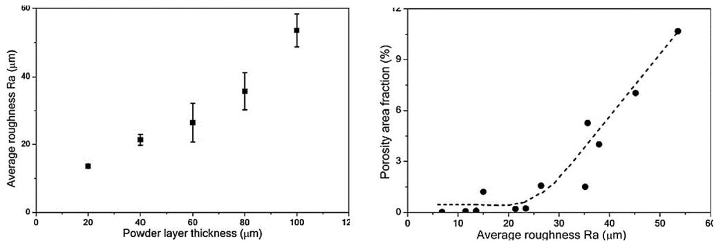
Figure I. 61 : (a) La rugosité Ra augmente avec l'épaisseur de couche. (b) Corrélation entre porosité et rugosité sur du Ti-6Al-4V (Qiu, 2015).
