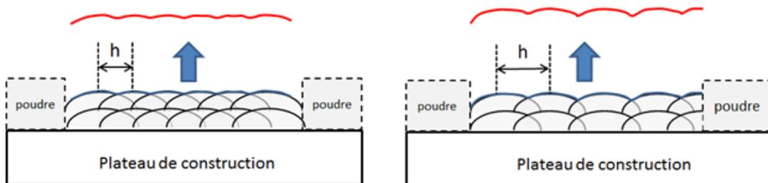
Figure IV. 40 : Influence de l'écart vecteur sur l'ondulation de la surface de fabrication.
