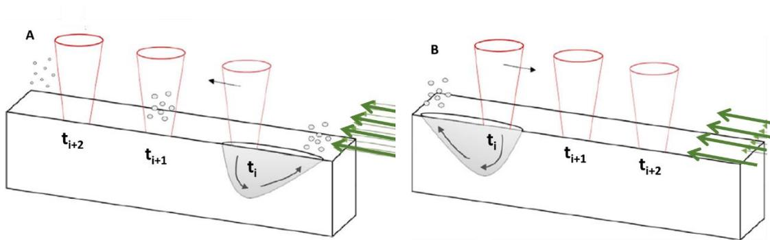
**Figure I. 68: Influence du sens de balayage sur l'évacuation des éjectas. Cas défavorable (A) : sens de balayage identique au sens du gaz, les éjectas se retrouvent sous le faisceau laser, se désintègrent en fines particules. Cas favorable (B) : sens de balayage contraire au sens du gaz, les éjectas sont facilement évacués de la zone de construction (Answar, 2016).**
