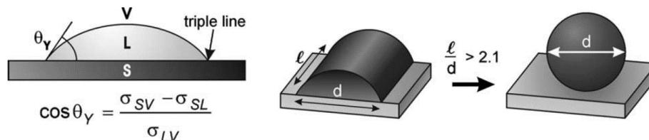
Figure I. 65: (a) Fusion d'un liquide sur un substrat, équation de Young avec  $\sigma_{SV}$ ,  $\sigma_{SL}$  and  $\sigma_{LV}$  les tensions superficielles des interfaces entre solide, vapeur et liquide. (b) Critère de balling: au-delà de  $l/D > 2$ , le bain liquide approximé par un demi cylindre sphéroïdisé (Kruth, 2004).
