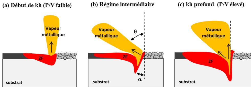
**Figure III. 67 :** Relation entre l'inclinaison de la colonne de vapeur et la géométrie du capillaire : la colonne de vapeur passe par une inclinaison maximale ( $\theta$  élevé) avec la formation progressive du capillaire puis se raidit à fort P/V (rappel :  $\theta = \pi/2 - \alpha$ ).
