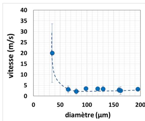
**Figure III. 46 :** Vitesse des particules éjectées en fonction de leur diamètre (D200\_E60).
