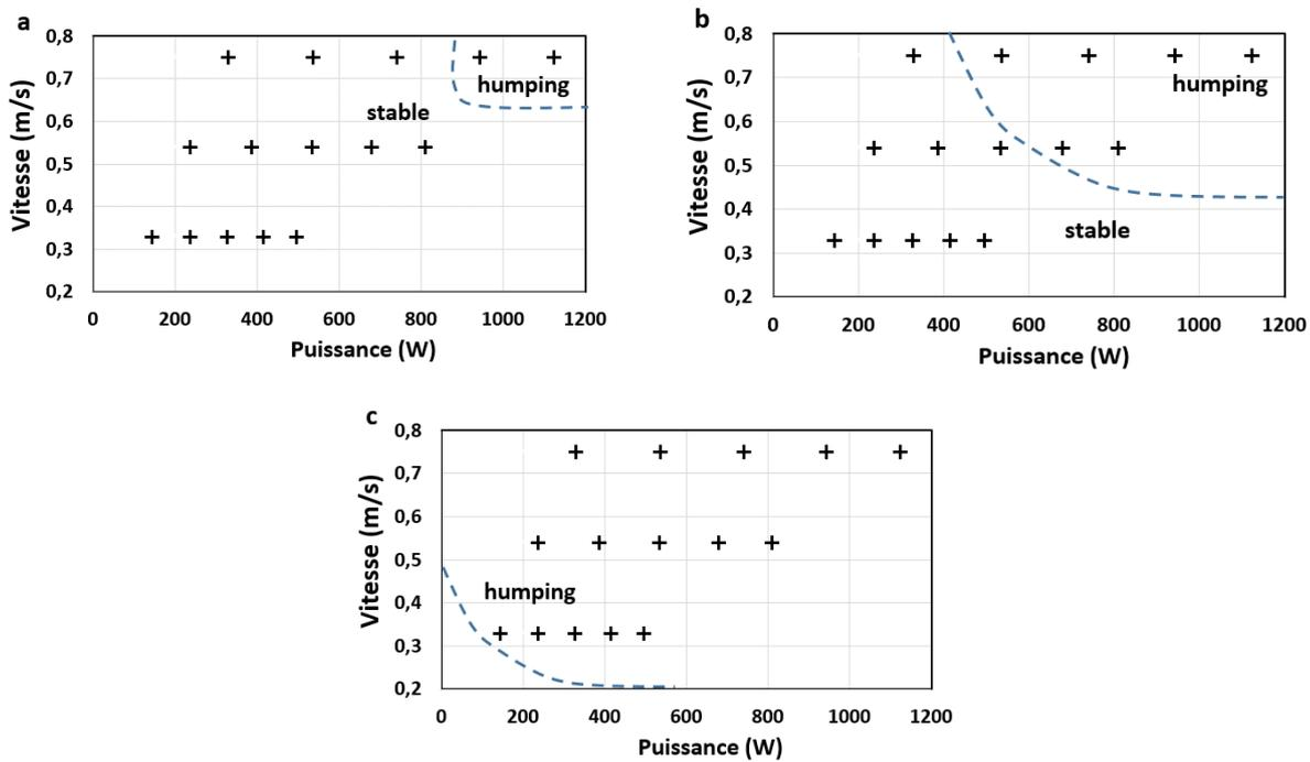
Figure III. 27 : Influence de l'épaisseur de poudre sur les seuils de formation des instabilités (D100) (a) pleine tôle, (b) 50 μm, (c) 100 μm.
