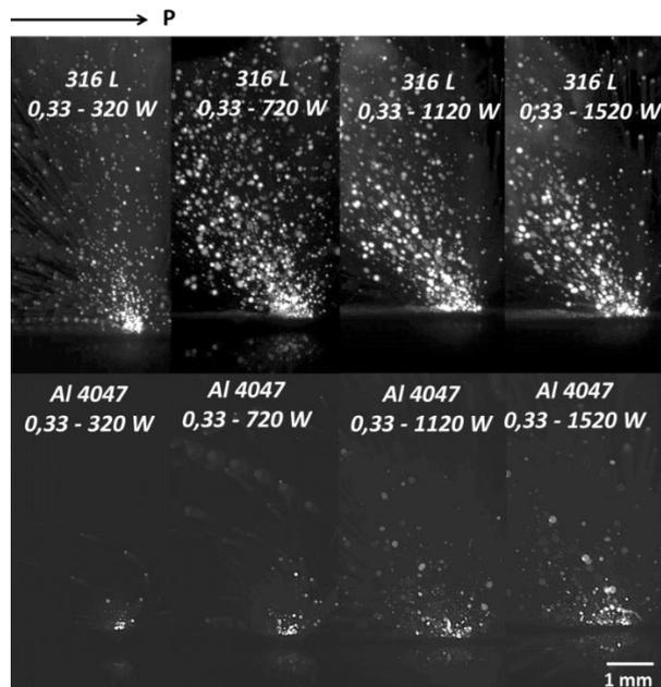
**Figure III. 92 : Comparaison de la dynamique d'éjection entre le 316L et Al4047 (somme de 33 images) (V330\_D200\_E60\_C4).**
