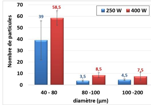
Figure III. 59: Histogramme des éjectas pour 250 et 400 W.
