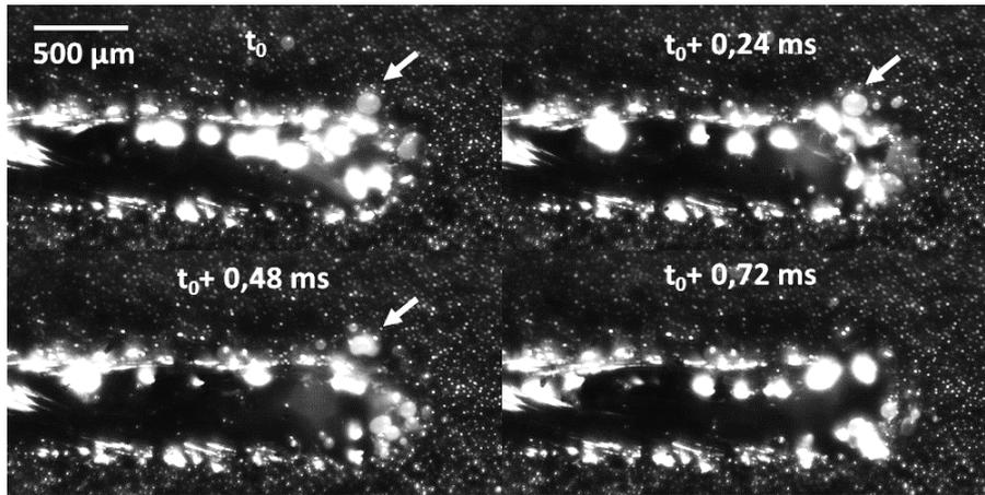
Figure IV. 47 : Images successives par caméra rapide. Suivi d'un éjecta (formé et intégré au bain liquide) à P720\_V330\_D600, soit 8 J/mm<sup>3</sup>.
