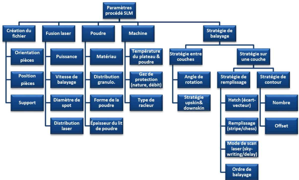
Figure I. 15 : Synthèse des principaux paramètres intervenant en SLM.
