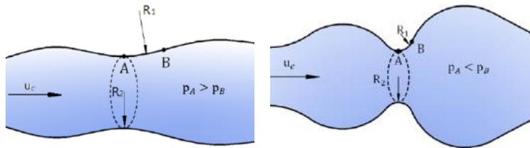
Figure I. 30 : Schéma du mécanisme d'instabilité de Rayleigh. Le bain liquide est instable lorsque (a)  $\frac{1}{R2} \gg \frac{1}{R1}$  et stable pour (b)  $\frac{1}{R1} \gg \frac{1}{R2}$  au point A (Wei, 2012).
