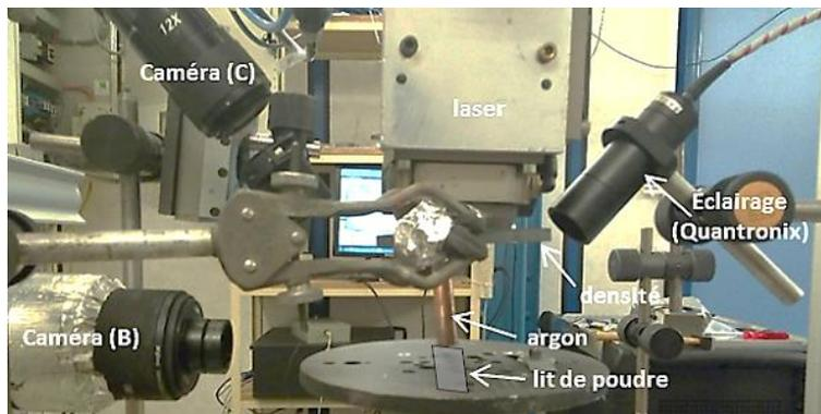
**Figure II. 13 : Montage avec une nouvelle focale (100  $\mu\text{m}$ ) et l'éclairage par laser vert (Quantronix).**
