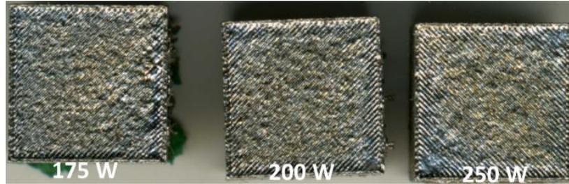
Figure IV. 38 : Surface de fabrication d'une pièce élaborée à différentes puissances (V750\_H120\_croisée).
