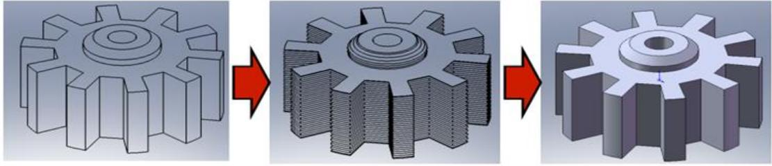
**Figure I. 5 : Principales étapes de la fabrication additive.**
