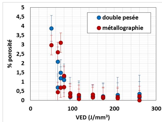
Figure IV. 9 : Comparaison entre les deux méthodes de mesure (D70\_E30).
