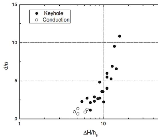
**Figure I. 37 : Utilisation du modèle de King (2014) [dérivé de (Hann, 2011)]. Rapport profondeur sur diamètre du spot ( $\delta/D$ ) en fonction de l'enthalpie normalisée  $\Delta H/\Delta H_s$  pour une couche de 316L de 50  $\mu\text{m}$  (Scipioni Bertoli, 2017).**
