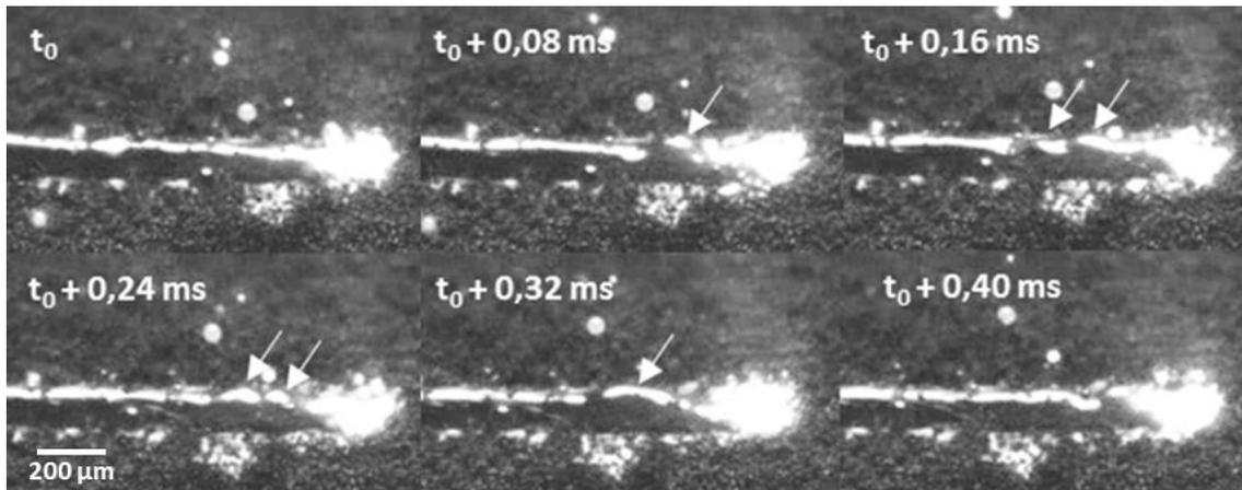
Figure III. 18 : Analyse par vidéo rapide (12500 im/s) des instabilités hydrodynamiques : formation de humps (bosses) à l’arrière de la zone d’interaction laser-matière par remontée de la zone fondue (P263\_V600\_E60\_D200).
