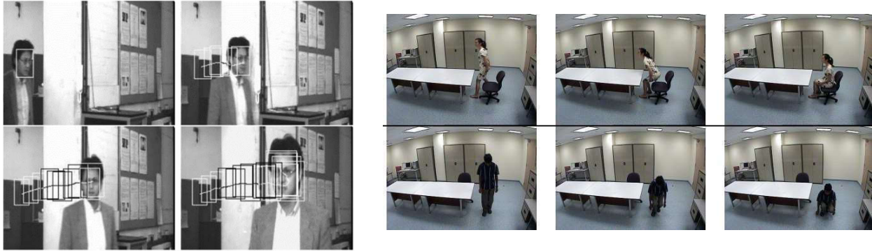
Figure 81. (à gauche) L'utilisation des réseaux de neurones récurrents, pour suivre le mouvement du visage humain, sur des trajectoires en 2D. (à droite) la reconnaissance du mouvement humain sur un plan 2D.
