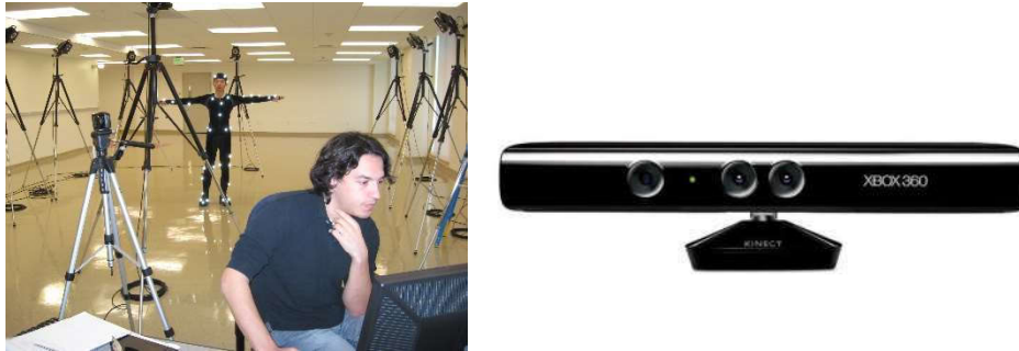
Figure 8. A gauche le système de capture de mouvement Vicon, à droite la Kinect, qui est le second système utilisé dans la capture de mouvement pour nos travaux.
