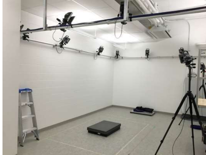
Figure 39. Le système de capture de mouvement « Vicon » basé sur les caméras infrarouges et les marqueurs.
