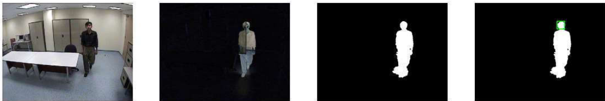
Figure 82. Traitement des enregistrements vidéo en images qui extraient la silhouette de la personne en mouvement.
