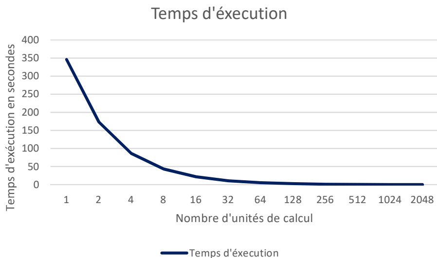
Figure 76. Estimation de temps de calcul par rapport au nombre d'unités de calcul utilisées, selon la loi de Amdahl.
