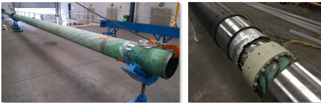
Figure II.26 Photo de l'installation des câbles à fibre optique Sensolux TM en hélice autour d'une section de 10m (gauche). Photo des connections entre les tronçons des tubes de type PIP.
