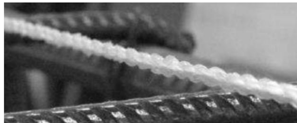
Figure I.5 Photographie d'un câble pour la mesure de déformation en traction ou en compression avec un relief extérieur ayant une forme sinusoïdale
