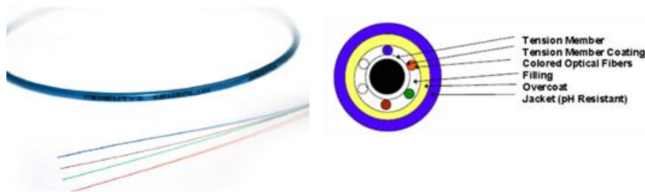
Figure II.2 Photo et coupe transversale du câble à fibres optiques Sensolux TM® de la société Cementys. Sa conception lui permet de réaliser des mesures de déformation et de température.
