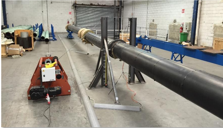
Figure II.28 Système de levage et de flexion du tube de type PiP générant ainsi une flexion 3 points.
