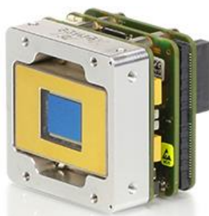
Figure 5 - Bloc détecteur "XSW" InGaAs (coupure à 1.7\mu\text{m} ) de chez Xenics au format 640 \times 512 pixels, au pas de 20\mu\text{m} (Température de fonctionnement de 220\text{K} ).
