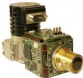
Figure 10 - IDDCA de chez IRnova au format 640x512 pixels au pas de 15\mu\text{m} ( \lambda_c=5\mu\text{m} , T_{\text{det}}=90\text{K} ) [36].
