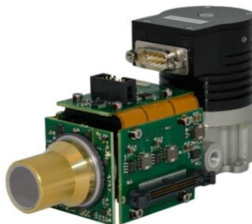
Figure 8 - Bloc détecteur " IRnova 640-LW" à base de QWIP commercialisé par IRnova, au format 640x512 pixels au pas de 15 \mu\text{m} , présentant une longueur d'onde pic à 8.5 \mu\text{m} et une température de fonctionnement de 70K.
