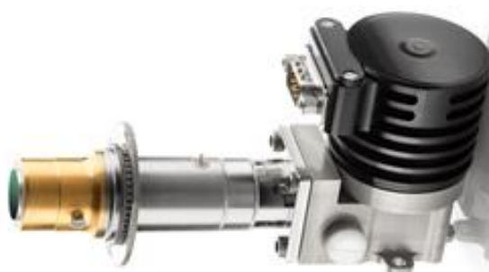
Figure 7- IDDCA MCT "Scorpio" LWIR au format 640x520 au pas de 15 \mu m ( T_{\text{dét}} = 80\text{K} ) [25].
