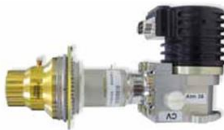
Figure 6 - IDDCA MCT "Jupiter" MWIR de chez Sofradir au format 1280x1024 pixels au pas de 15 \mu m ( T_{\text{dét}} = 90\text{K} ) [24].
