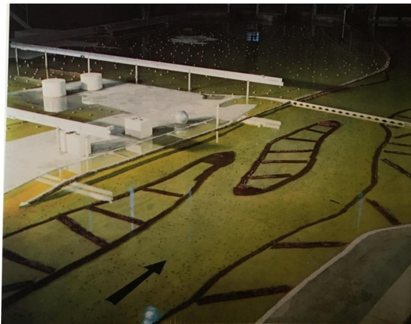
Figure 43 : Modèle réduit de la centrale nucléaire de Chinon et de la Loire, EDF/LNH, 1979
