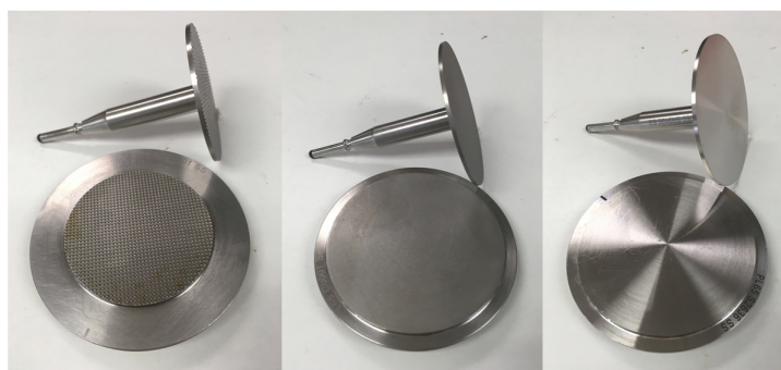
FIGURE 2.6 – Les surfaces utilisées en géométries de disques parallèles du rhéomètre. De gauche à droite : surfaces striées (diamètre 40 mm), surfaces sablées (diamètre 60 mm), surfaces lisses (diamètre 60 mm).
