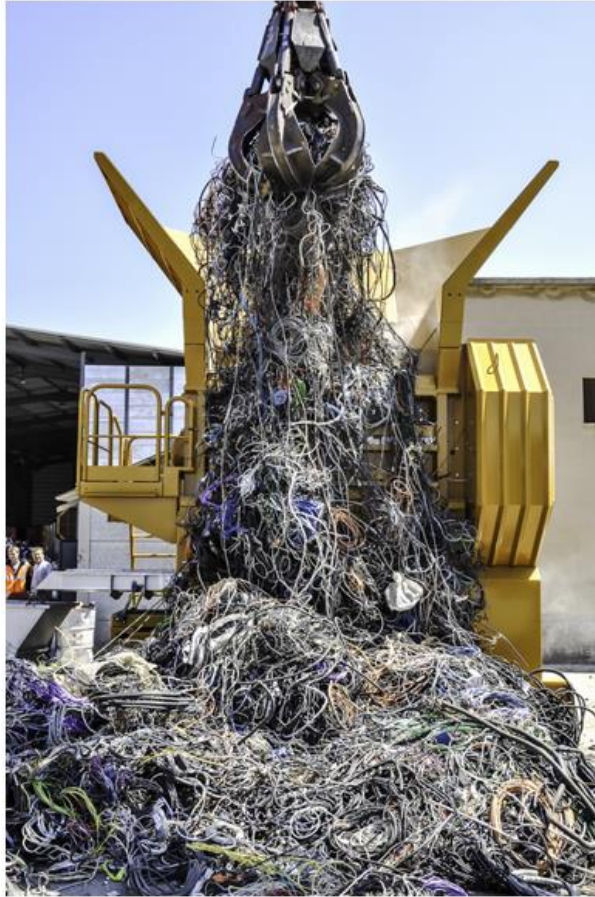
Figure 3-9 Visualisation du prébroyage des câbles chez MTB
