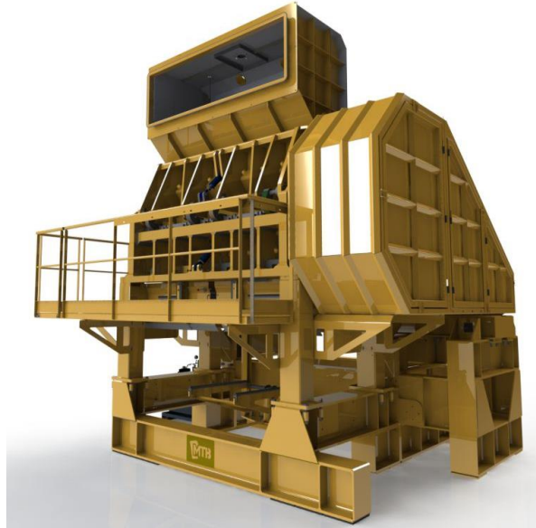
Figure 2-20 Visualisation d'un broyeur SRP 2400 de la gamme des granulateurs rapides conçu par MTB
