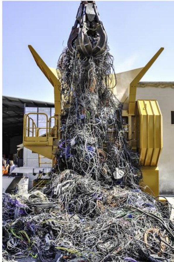
Figure 3-9 Visualisation du prébroyage des câbles chez MTB
