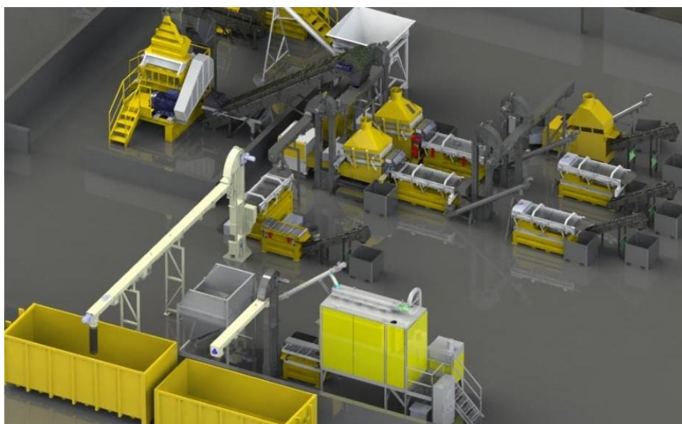
Figure 3-20 Visualisation de la ligne de recyclage des câbles en cuivre chez MTB – phase affinage et séparation
