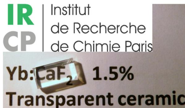
FIGURE II.26 – Échantillon découpé et poli d'une céramique Yb:CaF<sub>2</sub> dopé 1,5 % (extrait de [Sarthou 16]).
