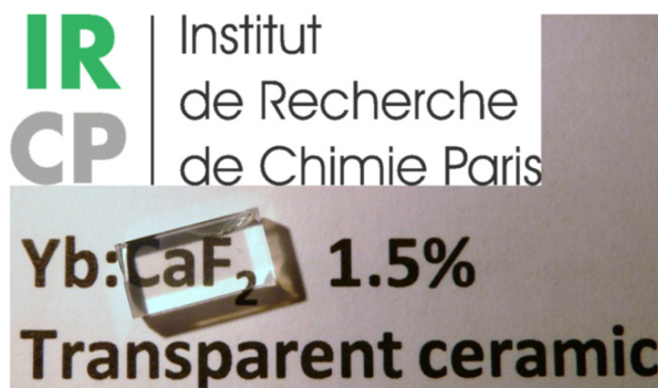
FIGURE II.26 – Échantillon découpé et poli d'une céramique \text{Yb:CaF}_2 dopé 1,5 % (extrait de [Sarthou 16]).
