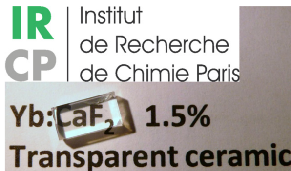
FIGURE II.26 – Échantillon découpé et poli d'une céramique Yb:CaF 2 dopé 1,5 % (extrait de [Sarthou 16]).
