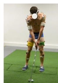
Figure 2 : volontaire équipé des marqueurs réfléchissants (gris) et des sondes EMG (noires)
