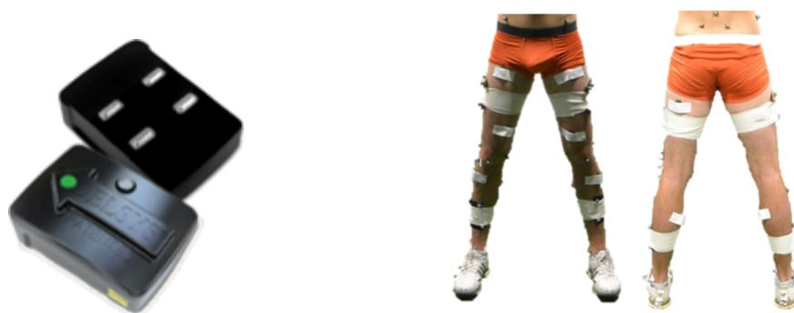
(a) Electrodes électro-myographiques sans fil (*Bluetooth*), Delsys Trigno [Del17] (b) Membres inférieurs du sujet 25(TP) avec les électrodes électromyographiques et les marqueurs.
