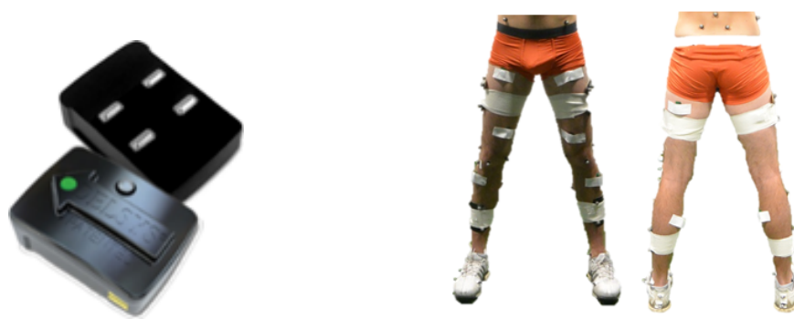
(a) Electrodes électro-myographiques sans fil ( Bluetooth ), Delsys Trigno [Del17] (b) Membres inférieurs du sujet 25(TP) avec les électrodes électromyographiques et les marqueurs.
