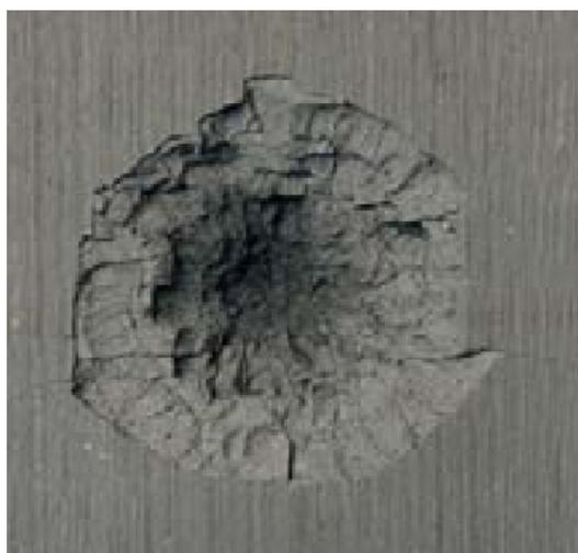
FIGURE 2.4 – Vue de dessus d'un cratère sur cible fragile (ici, en graphite) [69].
