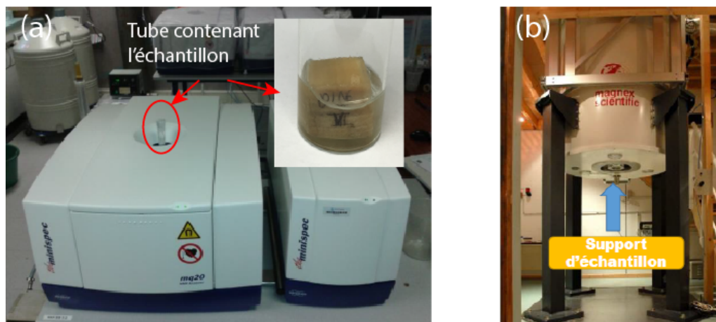
FIGURE 2.30 – (a) Spectromètre Bruker MINISPEC utilisé pour les mesures de relaxivité. Dans l'insert : image d'un échantillon imbibé dans le tube. (b) Imageur par résonance magnétique du Laboratoire Navier.
